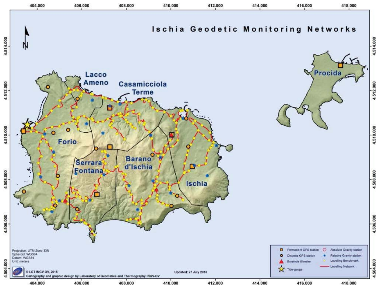
Figura 5.13.1 - Mappa delle Reti geodetiche per il monitoraggio delle deformazioni del suolo di Ischia
