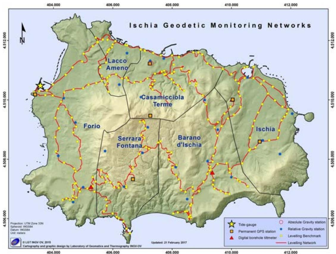
**Figura 17** - Reti geodetiche per il monitoraggio delle deformazioni del suolo dell'isola d'Ischia.
