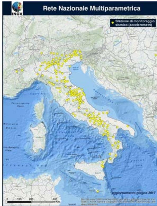
Fig. C1.3- Rete nazionale multiparametrica (accelerometri).
