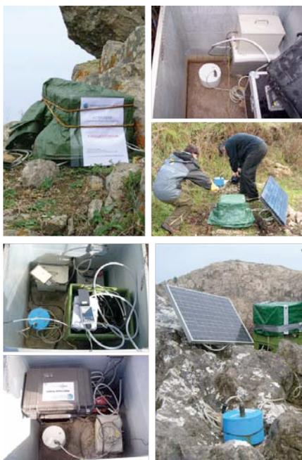
**Figura 2.** Qualche esempio di stazione sismometrica temporanea.
