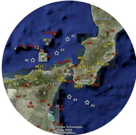
**Figura 1.** La rete sismica temporanea installata in occasione dell’esperimento “Messina 1908-2008”. I triangoli gialli rappresentano le stazioni temporanee, i cerchi rossi e verdi le stazioni della Rete Sismica Nazionale dell’INGV, i cerchi arancioni le stazioni della Rete Regionale Peloritana. Con le stelle bianche sono indicati i 5 OBS.
