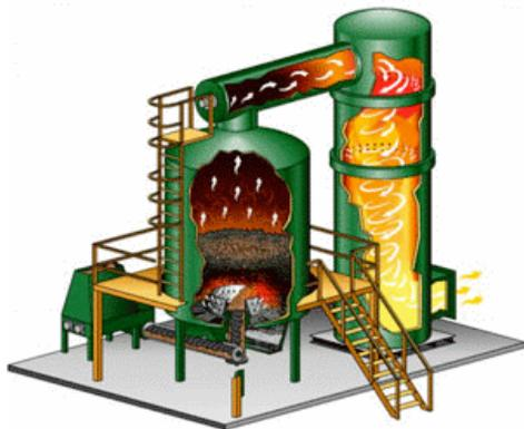
Figura 26. Impianto di gassificazione.
