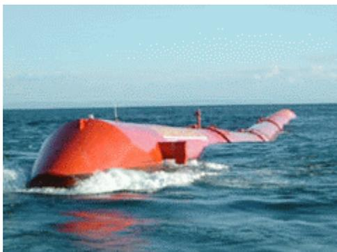
**Figura 61.** Foto del prototipo Pelamis (fonte pelamiswave.com).
