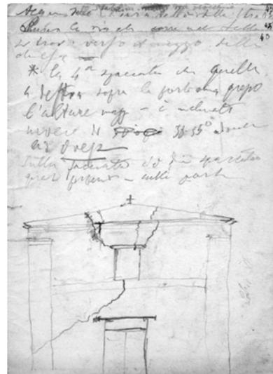
**Figura 5.** Metodo di Mallet per il calcolo dell'ipocentro (I) di un terremoto. A destra disegno di Mercalli del 1883 di una frattura a un edificio provocata dal terremoto di Casamicciola (Archivio storico Reale Osservatorio Vesuviano).
