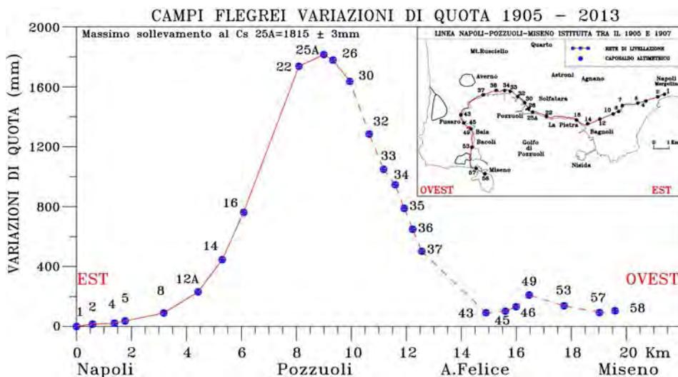
**Figura 5.** Ricostruzione storica della curva della deformazione residua dei movimenti verticali del suolo lungo la fascia costiera da Napoli a Miseno nel periodo 1905 – 2013. L'errore massimo è stato calcolato al caposaldo 58 ( $E_{max} = \pm 6.6$  mm). Nell'inserto la mappa di figura 4 a destra.
