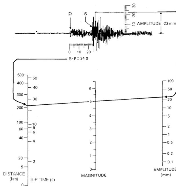
**Figura 5.** Nomogramma con cui è possibile determinare graficamente la magnitudo Richter di un terremoto. Su un sismogramma registrato ad una stazione sismica sono misurati l'ampiezza massima e l'intervallo temporale tra l'onda S e P (S-P), dal quale si ricava la distanza epicentrale. Il segmento che congiunge i valori di ampiezza e S-P intercetta la scala di magnitudo.
