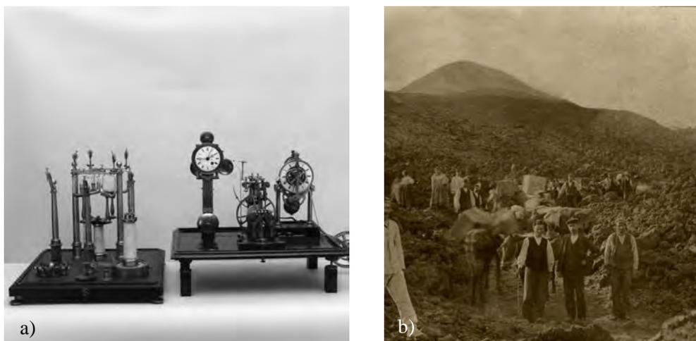
**Figura 1.** Il sismografo elettromagnetico da stazione di Luigi Palmieri del 1856 (a); il trasporto del sismografo portatile nel 1891 (b).
