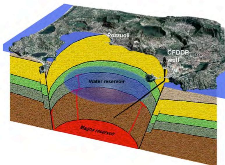
**Figura 5.** Schema del pozzo deviato di profondità fino a 3.5 km previsto nel Progetto CFDDP.
