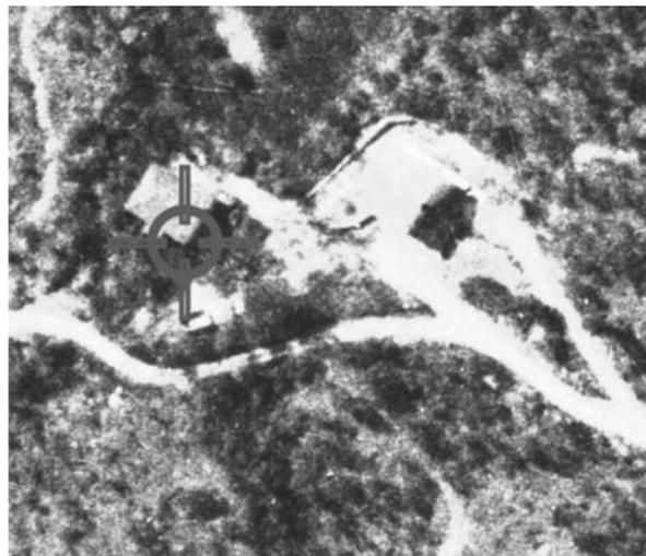
**Fig. 17** Particolare di una fotografia: il mirino individua lo spigolo di un piccolo casotto scelto come punto di controllo.
