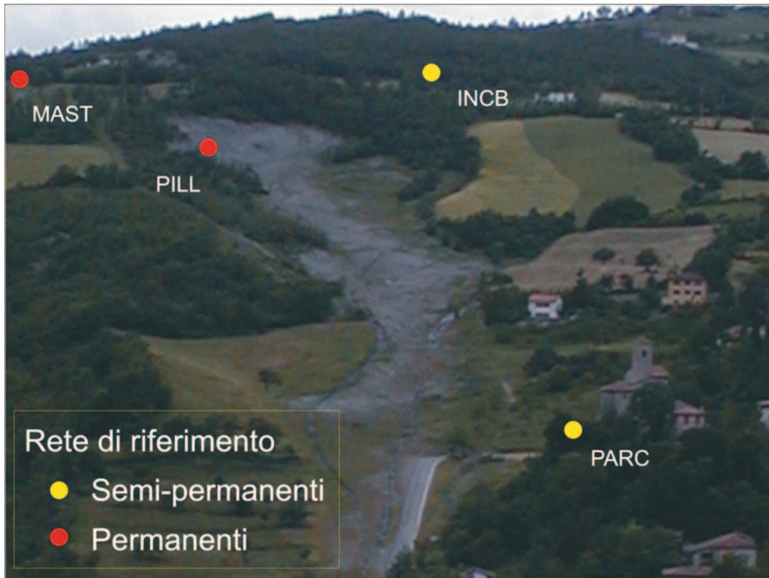
**Fig. 3** Rete GPS di riferimento. Le stazioni MAST, PARC ed INCB sono situate esternamente alla frana in un'area supposta e misurata stabile; la stazione PILL, monumentata su piastrino nella parte alta della frana, ha lavorato come stazione permanente contemporaneamente a MAST.
