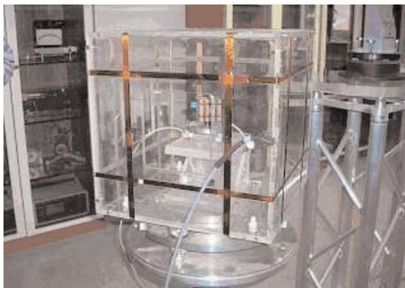
**Figura 8.** Magnetometro per la banda 0 Hz – 20 Hz.
