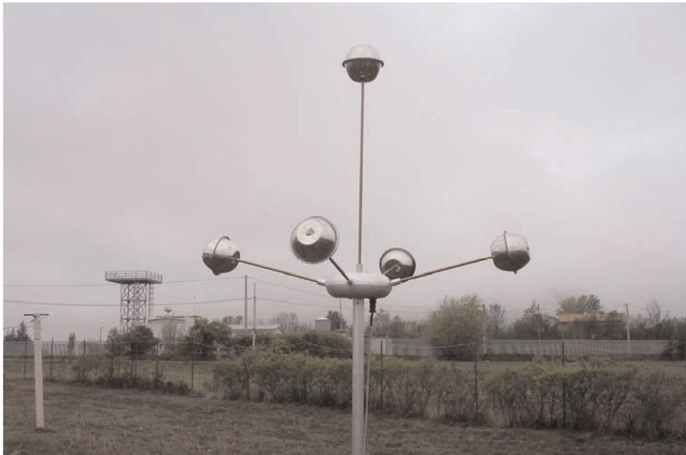
**Figura 1.** Antenna elettrica vettoriale.
