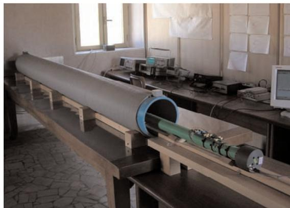
**Figura 9.** Sistema di calibrazione dei magnetometri a induzione.
