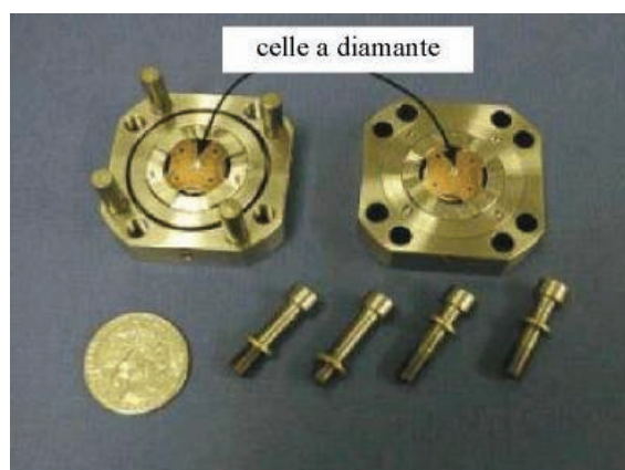
Figura 6. Elementi che costituiscono una cella a diamante.
