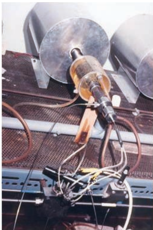
Figura 3 Esempio di autoclave a riscaldamento esterno per esperimenti a pressione fino a 0.4 GPa.
