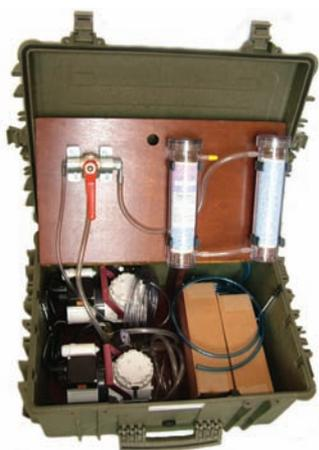
Figura 15 Valigia attrezzata per la depressurizzazione e la deumidificazione di vessel e bentosfere.
