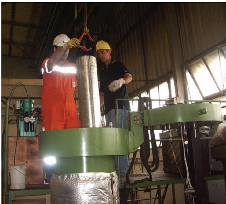
**Figura 16** Test in camera iperbarica presso la SONSUB, Marghera.
