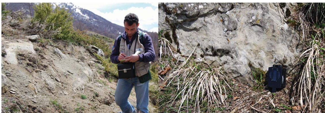
Figura 64 Piano di Faglia dei Monti della Laga al sito WPT PM269 e particolare del contatto bedrock -depositi di versante privo di evidenze di movimenti recenti.
