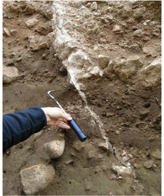
Figura 44 Dettaglio delle fratture con riempimento di carbonato di calcio (WPT CB61, 42.3047/13.4820). Figure 44 Fissures with filling of calcium carbonate (WPT CB61, 42.3047/13.4820).
