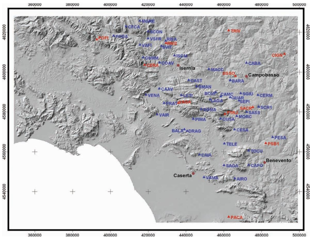
Figura 4 DTM dell'area Sannio-Matese con le stazioni GPS della rete SAGNET (in blu) e della rete RING (in rosso).
