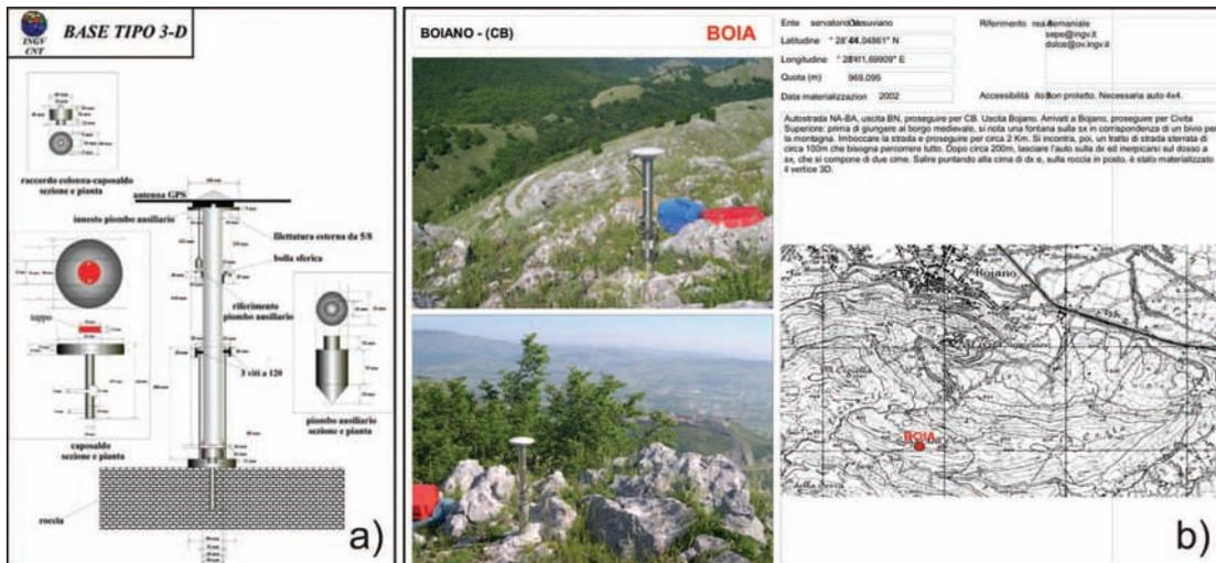
Figura 3 a) Schema di montaggio delle stazioni GPS; b) esempio di scheda monografica.
