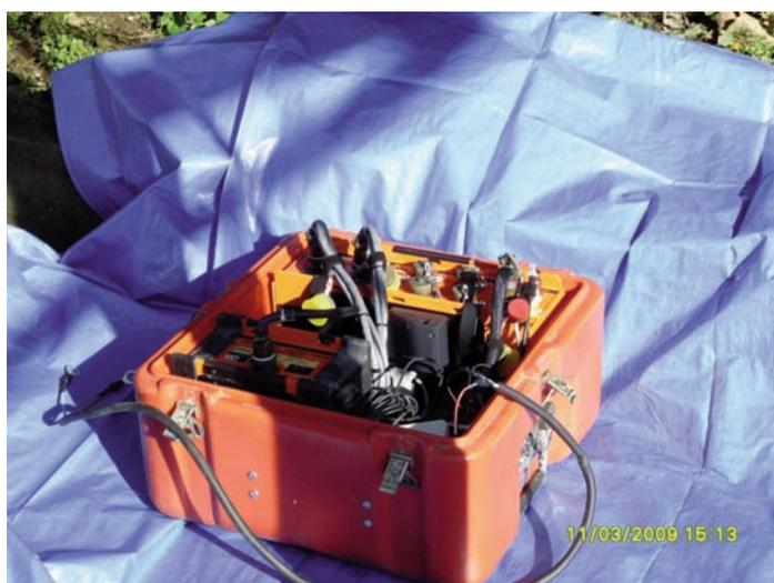
**Figura 5** Acquisitore *Quanterra Q330* con HD esterno *Baler-PB14F* in un contenitore a tenuta stagna.
