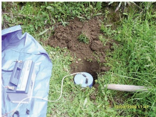
**Figura 9** Installazione del sismometro Lennartz LE-3D/5s alla stazione di Toiano (TOI5).
