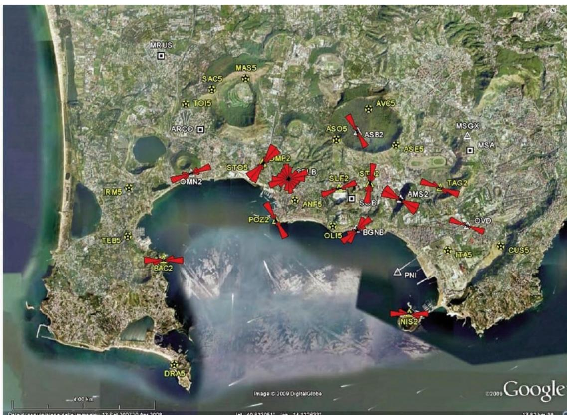
**Figura 19** Diagrammi a rosa e distribuzione spaziale delle direzioni di polarizzazione del *noise* nella banda di frequenze 1-10 s.
