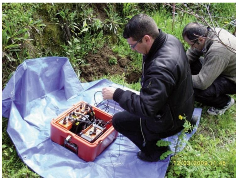
**Figura 6** Installazione dell'acquisitore *Quanterra Q330* alla stazione Toiano (TO15).
