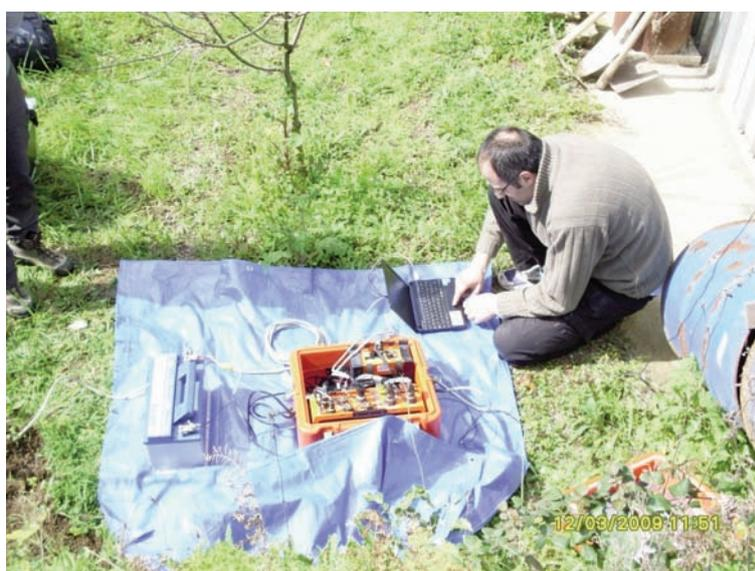
**Figura 7** Programmazione dell'acquisitore *Quanterra Q330* alla stazione Toiano (TO15).
