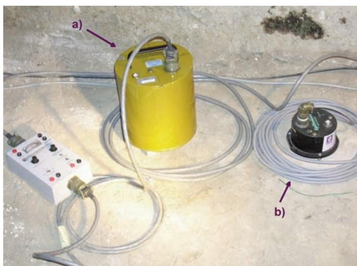
**Figura 4** Sismometro *Geotech KS-2000* (a), senza isolamento termico, ed accelerometro *Kinemetrics EpiSensor FBA ES-T* (b) installati presso la stazione multisensore di Celle (CELB).
