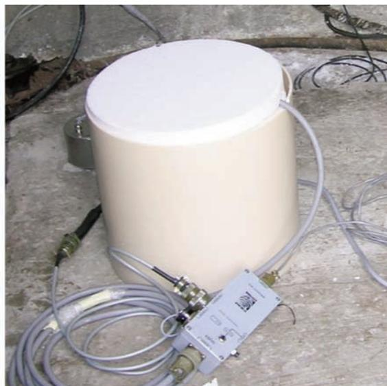
**Figura 10** Esempio di coibentazione di un sismometro Guralp CMG-40T. L'impiego di un cilindro di polistirolo ad alta densità dello spessore di 5 cm garantisce una semplice ed ottimale protezione dalle variazioni termiche.
