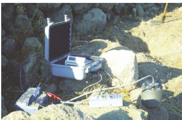
Figura 80 Installazione di una stazione Lennartz MARSlite equipaggiata con sismometro a larga banda Guralp CMG-40T. Sullo sfondo si nota lo scavo per il posizionamento interrato del sensore (foto D. Galluzzo).
