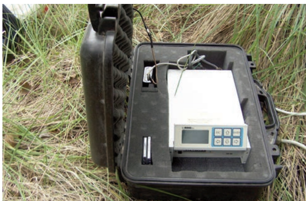
Figura 96 Stazione sismica Lennartz MARSlite installata alle pendici del vulcano Colima (foto M. La Rocca). Figure 96 Lennartz MARSlite seismic station installed on the slopes of Colima volcano (photo M. La Rocca).
