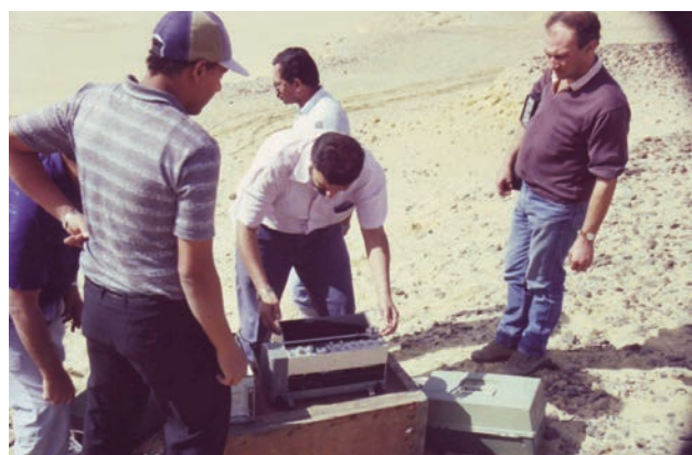
Figura 70 Sostituzione del rullo a carta affumicata del registratore Spregner MEW-800 in dotazione al Servizio Geologico Egiziano (foto M. Castellano).
