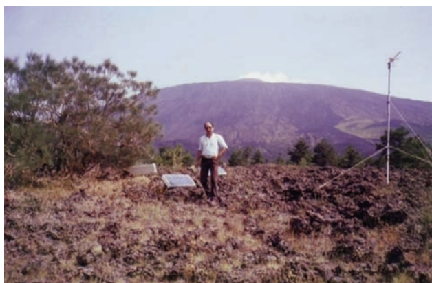
Figura 57 Installazione della stazione Lennartz PCM 5800 in trasmissione radio in località Monte Nespole, Adrano (foto J. Dorel).
