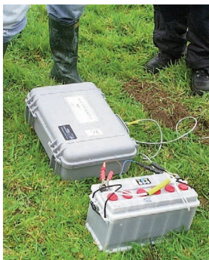
Figura 86 Installazione di una stazione sismica Lennartz MARSlite (foto M. La Rocca). Figure 86 Installation of a Lennartz MARSlite seismic station (photo M. La Rocca).
