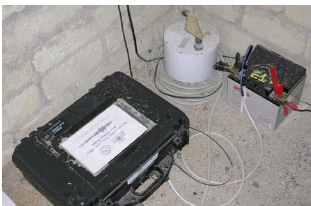
Figura 92 Stazione sismica Lennartz MARSlite e sensore Lennartz LE-3D/20s installati presso il sito dell'Oasi Naturalistica di Monte Nuovo (OMN2) (foto D. Galluzzo).
