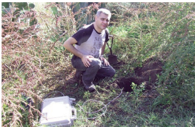
Figura 100 Installazione della stazione MARSlite in località Scari (foto M. Castellano). Figure 100 A MARSlite seismic station installation at the Scari site (photo M. Castellano).
