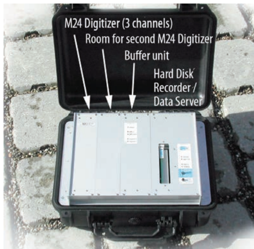
Figura 25 Stazione sismica Lennartz M24 (www.lennartz-electronic.de).
