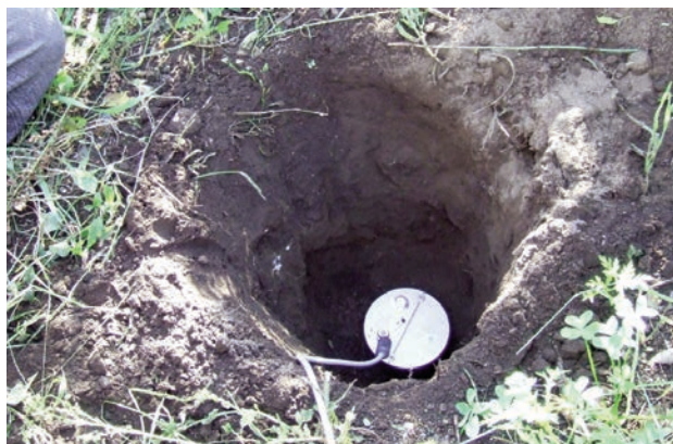
Figura 101 Posizionamento del sismometro Lennartz LE-3Dlite interrato a circa 40 cm di profondità (foto M. Castellano). Figure 101 A Lennartz LE-3Dlite seismometer installed to a depth of about 40 cm (photo M. Castellano).
