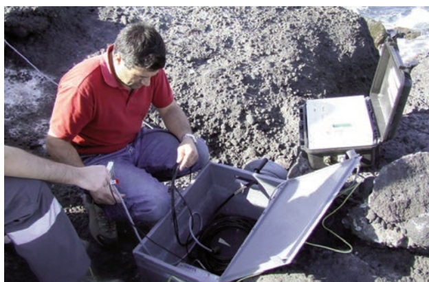
Figura 105 Collegamento degli idrofoni con la stazione digitale Lennartz M24 (foto M. Castellano).
