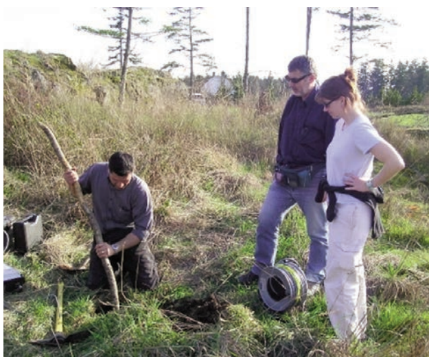
Figura 89 Una fase dell'installazione di una stazione sismica dell'array di Lopez Island. Figure 89 Seismic station installation at the Lopez Island array.
