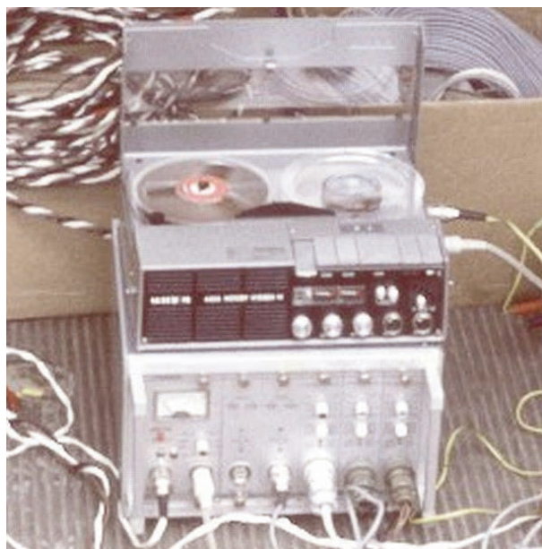
Figura 10 Esempio di stazione Lennartz MARS-66 a tre componenti collegata ad un registratore UHER Report 4000 ( www.lennartz-electronic.de ).
