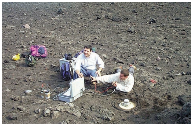
Figura 84 Installazione di un tiltmetro in acquisizione su una stazione Lennartz MARSlite in località Valle della Luna (foto M. Castellano). Figure 84 Installation of a Lennartz MARSlite seismic station equipped with a tiltmeter in the Valle della Luna site (photo M. Castellano).
