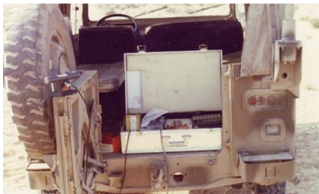
Figura 46 Stazione sismica, all'interno di una jeep dell'Esercito Tunisino, predisposta per la registrazione di uno degli scoppi (foto G. Milano). Figure 46 Seismic station, mounted in a vehicle of the Tunisian Army, ready for the shot recording (photo G. Milano).
