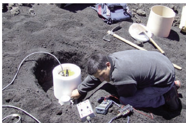
Figura 111 Regolazione del corretto posizionamento orizzontale del tiltmetro Applied Geomechanics (foto M. Castellano). Figure 111 Checking the levelling of the Applied Geomechanics tiltmeter (photo M. Castellano).
