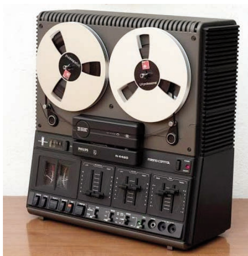
Figura 13 Esempio di registratore a nastro magnetico Philips N4420 con bobine da 18 cm ( www.radiomuseum.org ).
