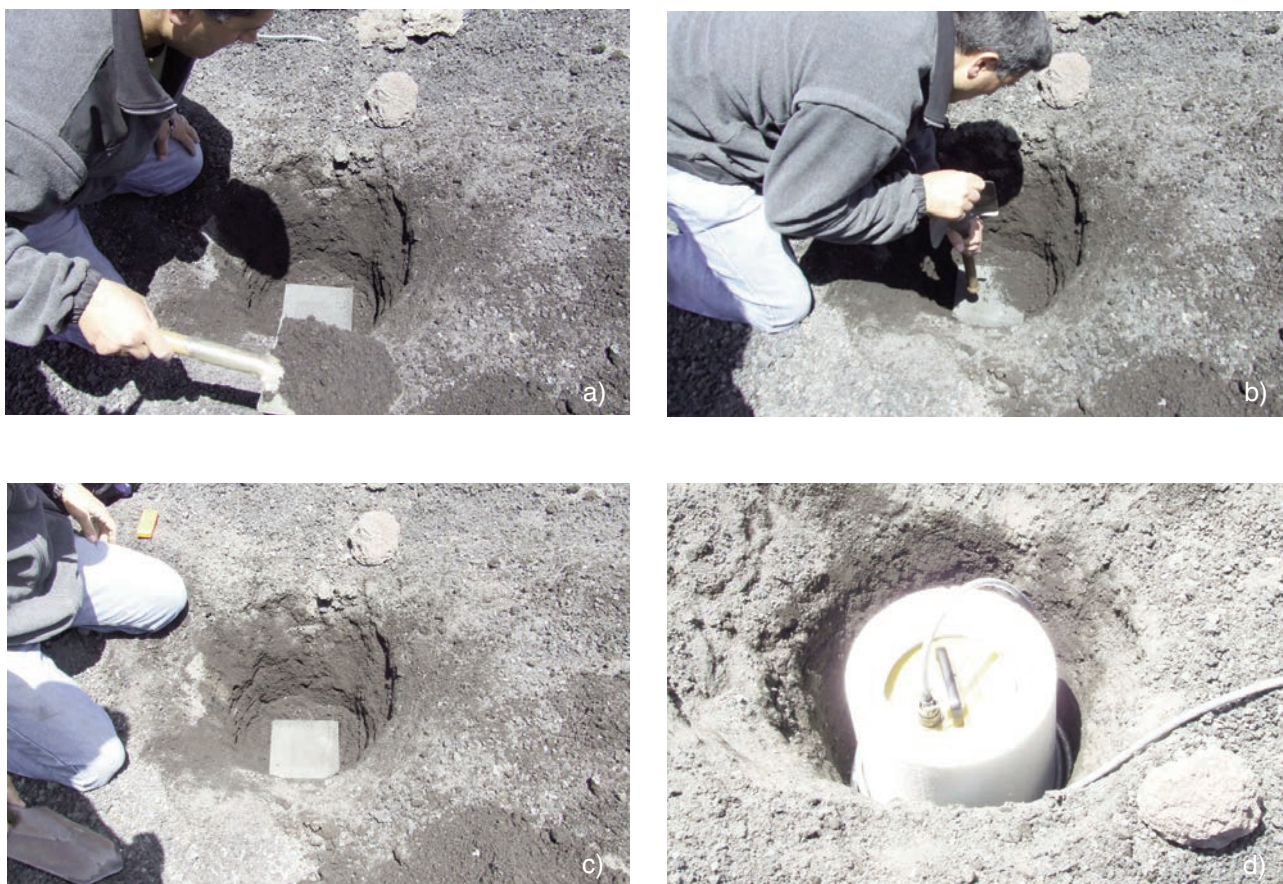
Figura 112 Procedure per un corretto posizionamento di un sensore a larga banda in materiale vulcanico. a) dopo aver scavato una buca profonda circa 40-50 cm, si posiziona sul fondo una mattonella di cemento; b) la mattonella di cemento viene pressata per ottenere un ottimale accoppiamento con substrato; c) viene controllato con una livella il corretto posizionamento della mattonella di cemento; d) si posiziona il sensore (in questo caso un Geotech KS-2000 ) opportunamente coibentato per ridurre gli effetti dell'escursione termica. Infine si copre il tutto con il materiale precedentemente rimosso (foto M. Castellano).
