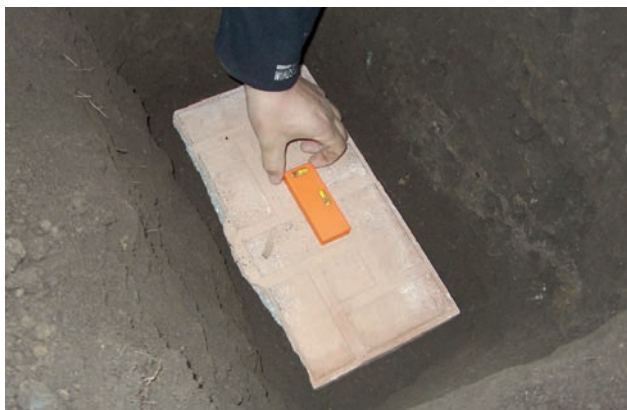
Figura 98 Predisposizione della base per il posizionamento del sismometro (foto D. Galluzzo). Figure 98 Arrangement of the seismometer basement in a vault (photo D. Galluzzo).
