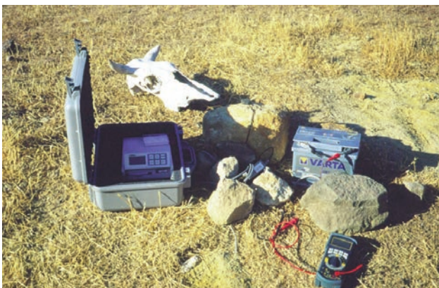
Figura 81 Installazione di una stazione sismica Lennartz MARSlite appartenente all'array (foto D. Galluzzo). Figure 81 Installation of a Lennartz MARSlite seismic station belonging to the array (photo D. Galluzzo).
