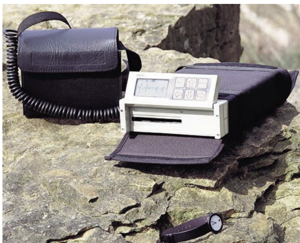
Figura 24 Stazione sismica Lennartz MARSlite equipaggiata con il lettore magneto-ottico (www.lennartz-electronic.de).
