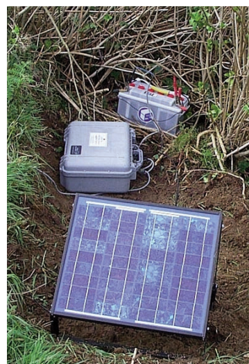
Figura 88 Stazione sismica Lennartz MARSlite alimentata con pannello solare (foto M. La Rocca). Figure 88 Lennartz MARSlite seismic station powered by solar panel (photo M. La Rocca).
