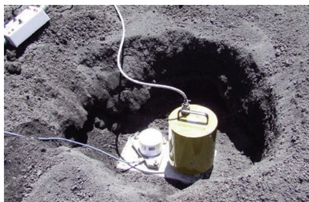
Figura 110 Sismometro Geotech KS-2000 e tiltmetro Applied Geomechanics posizionati su due mattonelle di cemento all'interno di una buca scavata nelle vulcaniti (foto M. Castellano). Figure 110 Geotech KS-2000 seismometer and Applied Geomechanics tiltmeter siting in an appropriate vault buried in volcanic material (photo M. Castellano).
