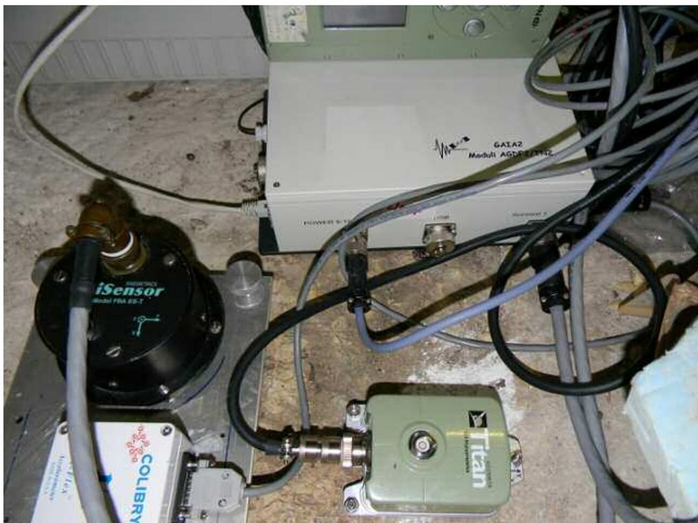
**Figura 11** Accelerometri *Episensor* FBA ES-T e *Colibrys* SF3000L posizionati sulla stessa base per la prova comparativa.
