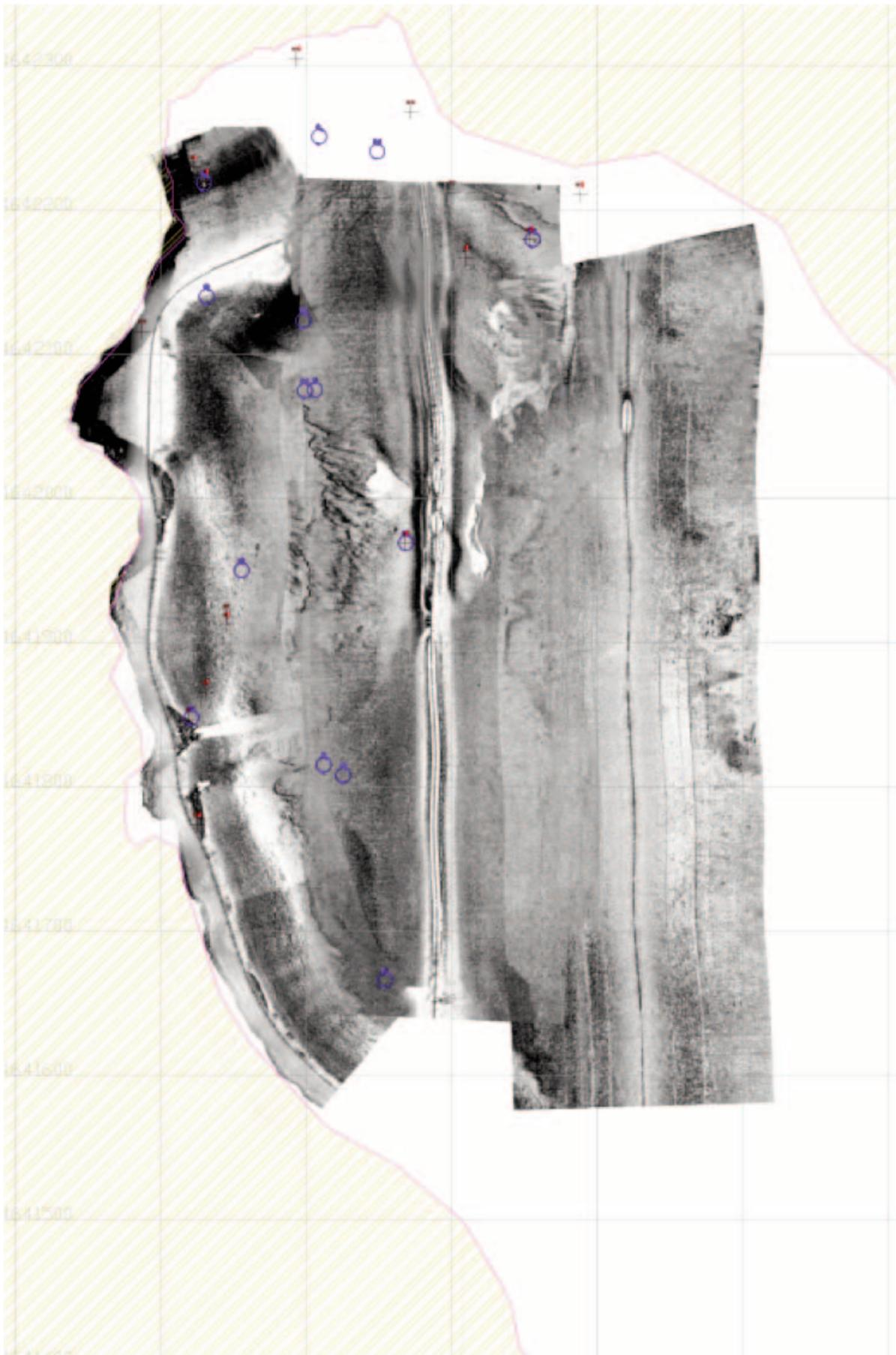
**Figura 26** Ricostruzione da SSS del fondo del Lago di Scanno. I *target* identificati sono riportati in blu.
