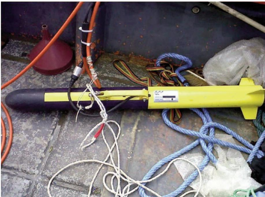
**Figura 16** Il Side Scan Sonar Geoacoustics.
