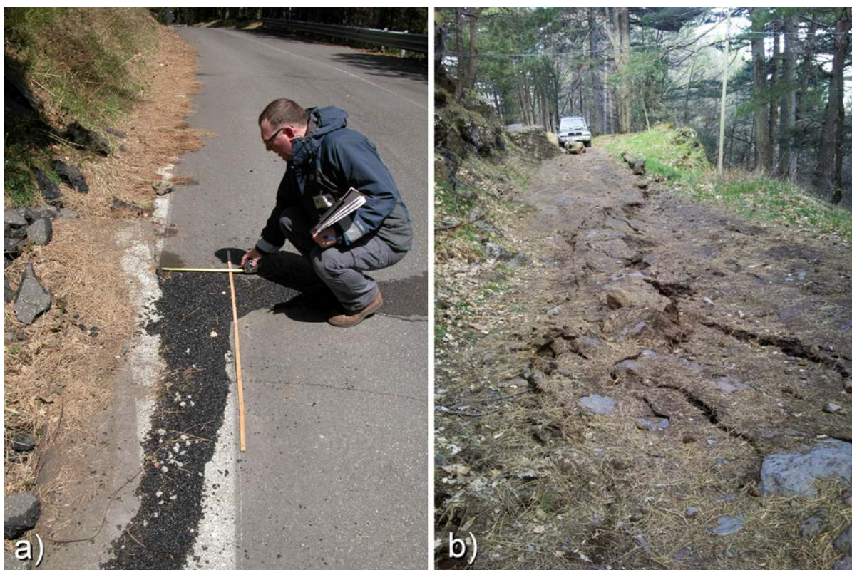
Foto 4 a) Piano Pernicana: dislocazione della rottura principale lungo la SP Mareneve; b) Mandra del Re: fagliazione superficiale sviluppata al piede delle scarpate su suolo forestale (Foto A. Bonforte).
