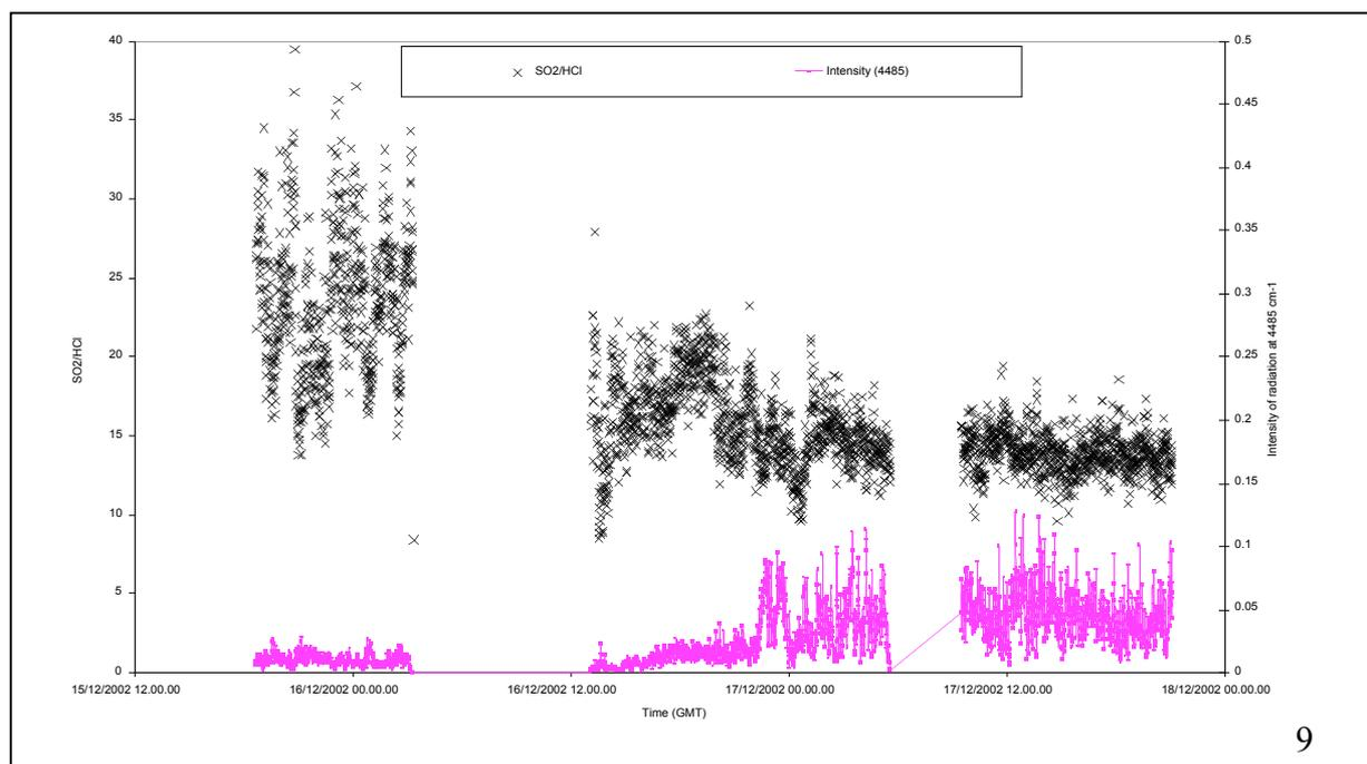
**Figura 9.** Grafico rappresentante i valori di SO<sub>2</sub>/HCL registrati durante le misure FTIR in continuo dal 15/12/2002 al 18/12/2002 a Serra La Nave.
