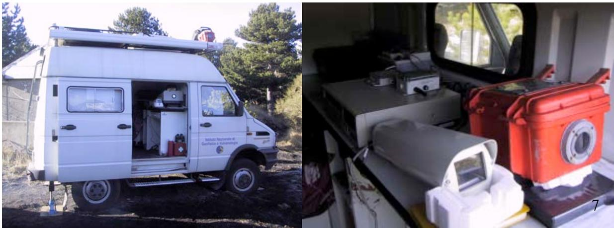
**Figura 7.** Mezzo mobile dell'Istituto Nazionale di Geofisica e Vulcanologia con all'interno la telecamera Sony FCB 470 LP, il videoregistratore time-lapse Panasonic AG 6040, l'FTIR ed il radiometro.
