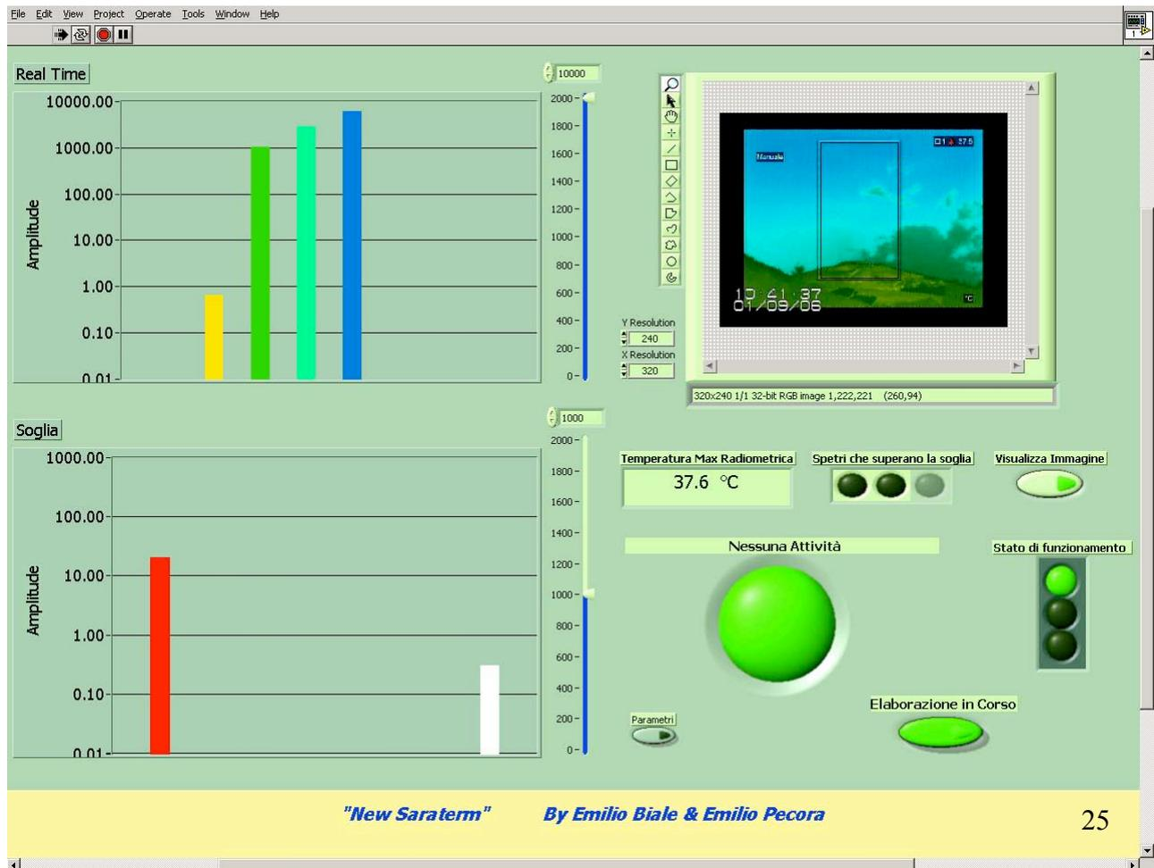
Figura 25. Front Panel del software New Saraterm realizzato in ambiente LabView.
