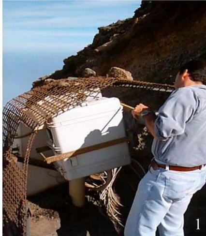
**Figura 1.** Telecamera di Stromboli distrutta dall'esplosione del 5 Aprile.
