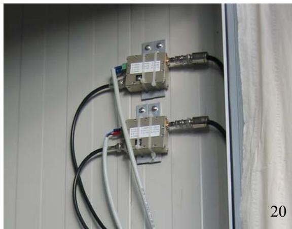
**Figura 20.** Modulatori MTX 2100 utilizzati a quota 400 m s.l.m..
