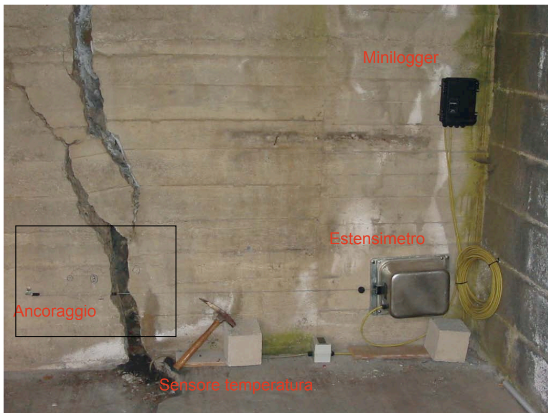
Figura 2 Foto installazione estensimetro ET2. L'ingrandimento del riquadro è riportato in fig. 5
