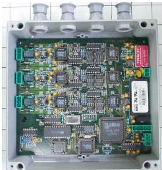
**Figura 11: Particolare del Modulo AGDF1 inserito nel contenitore stagno in alluminio**
