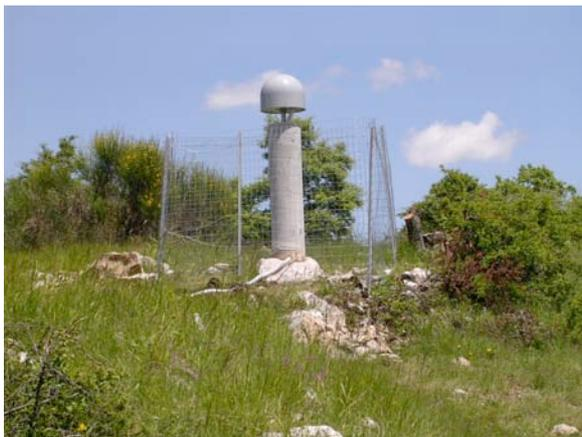
**Figura 2** Stazione di Morcone (BN) (SACR) Monumento tipo pilastro in C.A. ancorato su affioramento di roccia calcarea.
