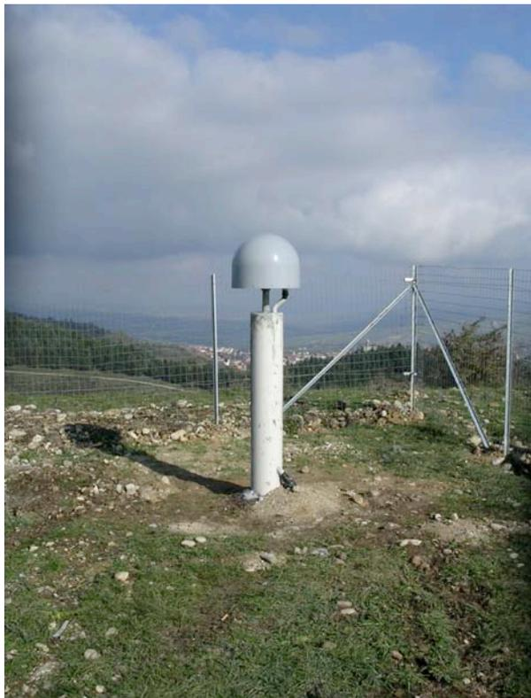
**Figura 9** Foto del monumento tipo micropalo realizzato presso la Stazione di Carife (AV).
