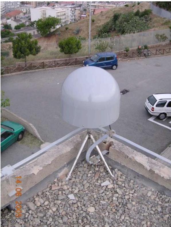
**Figura 4** La foto mostra la Stazione permanente di Villa S. Giovanni (VLSG). Il monumento è ancorato alle travi in C.A. di un edificio scolastico di due piani. Le tre aste che sorreggono l'antenna sono in acciaio inox pieno (diametro 25 mm).
