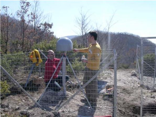
**Figura 5** La foto rappresenta il monumento tipo tripode superficiale (SCIGN) della stazione di Valle Agricola Caserta (VAGA). Il tripode è ancorato su di un affioramento di roccia calcarenitica.
