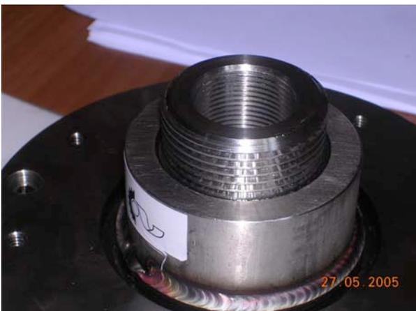
**Figura 19** Posizionamento dell'anello adattatore sul mount della SCIGN.
