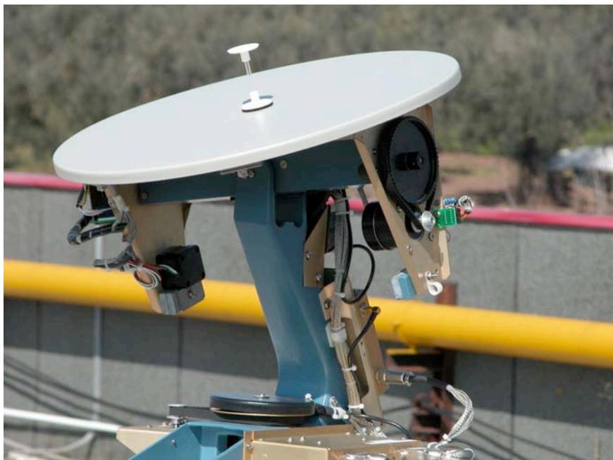
**Figura 4** Particolare dell'antenna AVHRR presso la sede INGV-ROMA: Nella foto si notano due dei tre motori che permettono all'antenna di seguire il passaggio del satellite.
