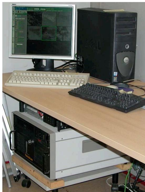
**Figura 6** Particolare del sistema di acquisizione presso la sede INGV di Roma, sezione CNT. Nella foto è possibile intravedere una visualizzazione di alcuni dati acquisiti. È inoltre visibile il gruppo di continuità che permette l'acquisizione e l'elaborazione dei dati anche in caso di black out.
