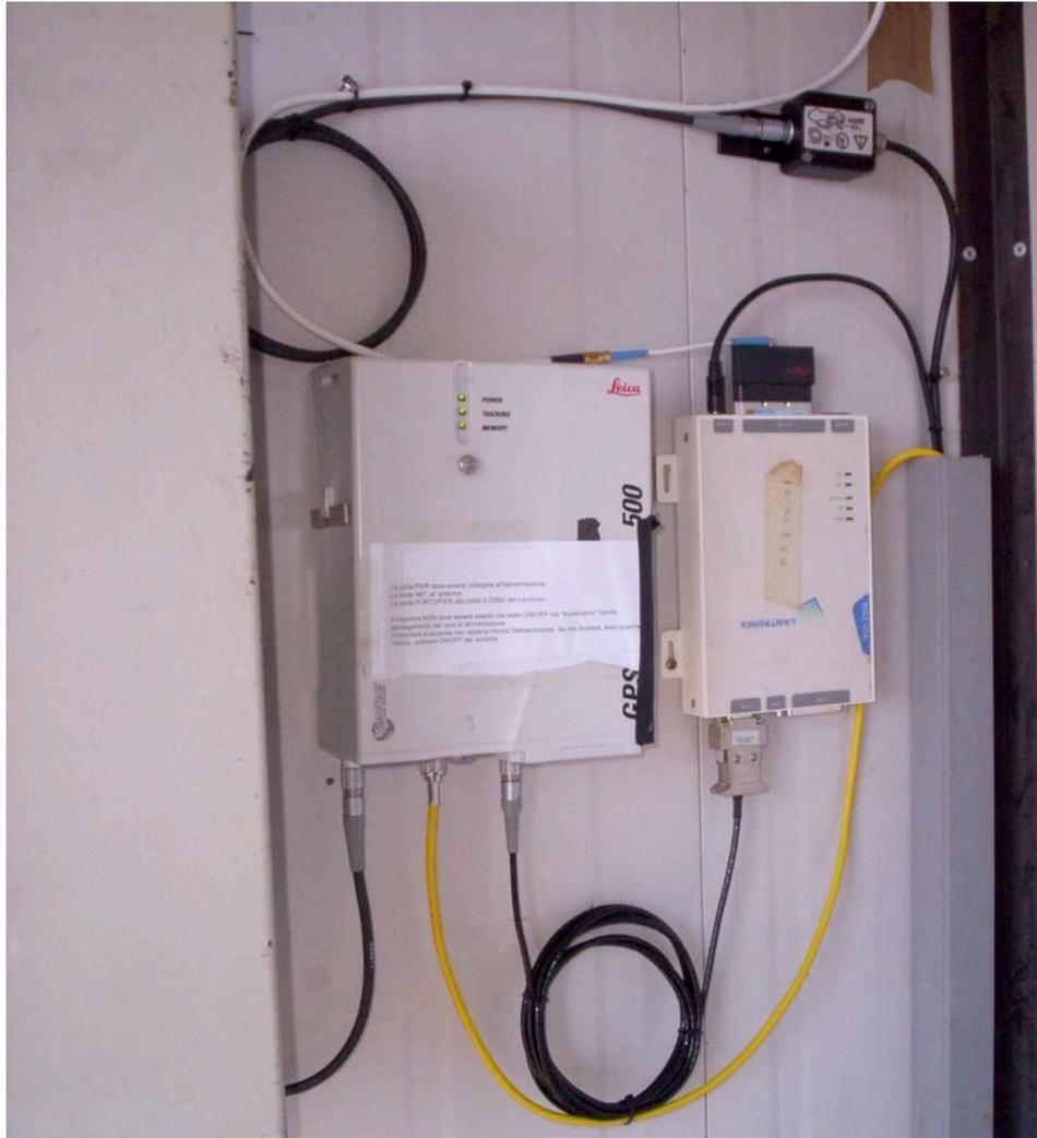
**Figura 7** Stazione tipo con ricevitore GPS e convertitore rs232-Wi-Fi.
