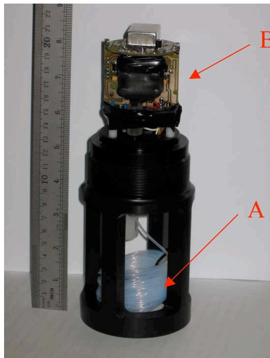
**Figura 1.** Particolare della sonda. In evidenza: il capillare semipermeabile (A) e il misuratore di pressione (B).
