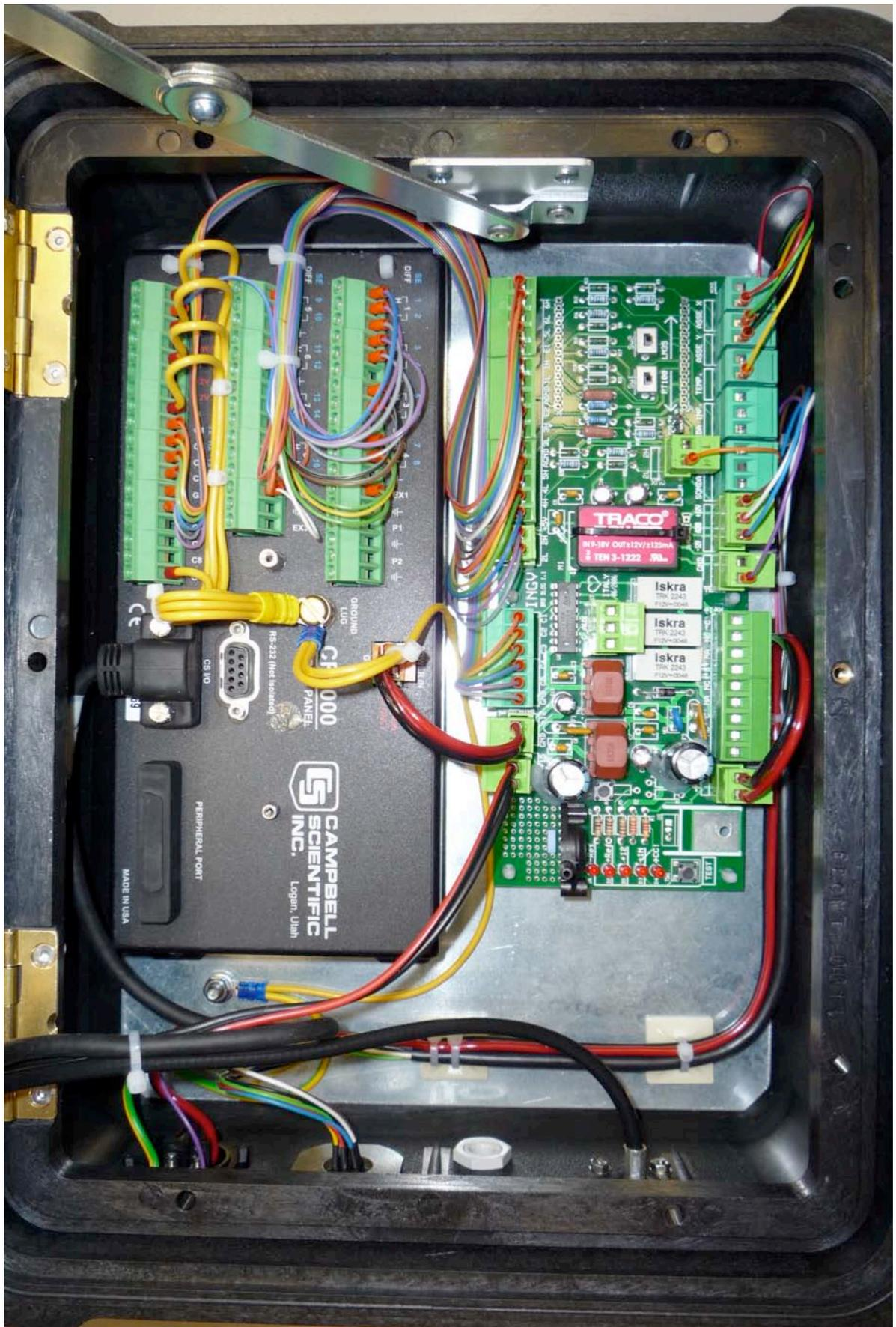
Figura 19. Cablaggio del circuito stampato con il datalogger.
