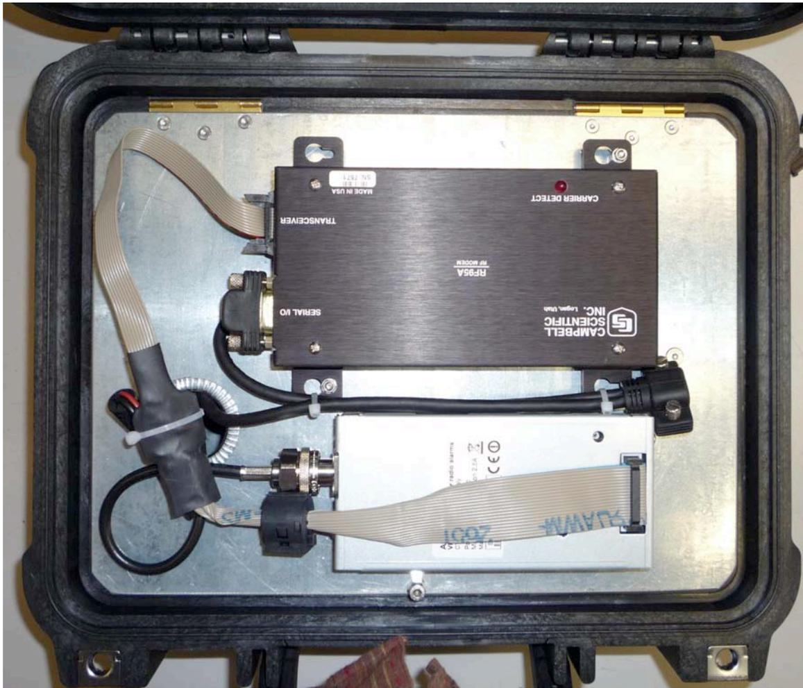
**Figura 20.** Radiomodem RF95 e ricetrasmittitore CTE. Si nota la piastra di disaccoppiamento dalle interferenze elettromagnetiche.
