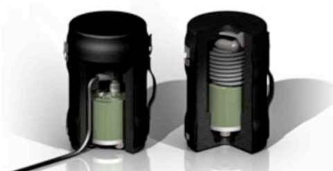
Figura 3. Il sensore a larga banda Nanometrics Trillium compact 120 s .
