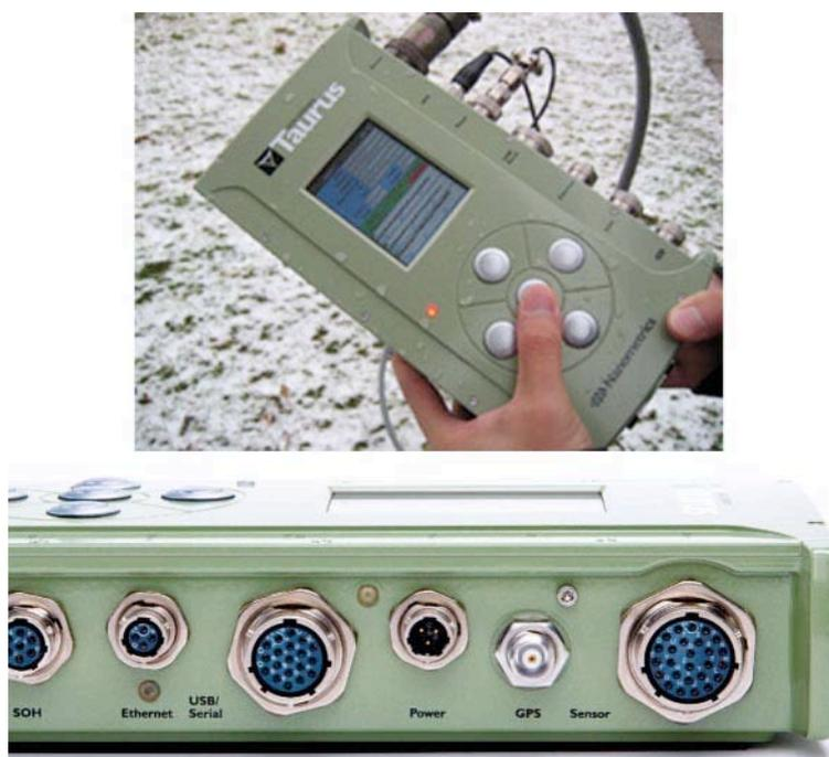
**Figura 8.** Il digitalizzatore *Taurus* della *Nanometrics*. Da sinistra a destra: connettore per sensori ausiliari (*SOH*); connettore per il collegamento *ethernet*; connettore per collegamento USB/Seriale; connettore di alimentazione (*power*); connettore per l'antenna GPS; connettore per il collegamento del sensore.
