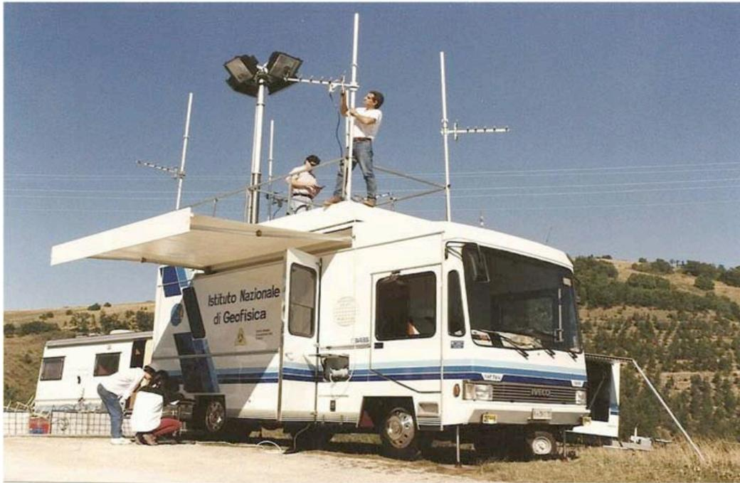
**Figura 1.** Centro di acquisizione mobile delle stazioni in telemetria digitale, realizzato nel 1990 e utilizzato per la prima volta durante il terremoto di Potenza del 1990. In foto è mostrato il suo utilizzo durante la sequenza sismica di Colfiorito (1997-98).
