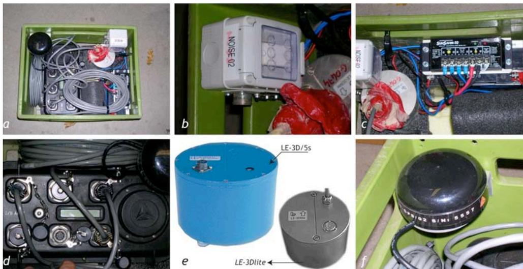
**Figura 15.** Assemblaggio delle stazioni per le prove di rumore. Tutta la strumentazione è alloggiata e opportunamente fissata all'interno di una cassa utile anche per il trasporto (a). La scatola ospita un interruttore di accensione stagno (b), l'antenna GPS (f) e un regolatore solare (c) che permette l'utilizzo con pannello solare o alimentatore esterno.
