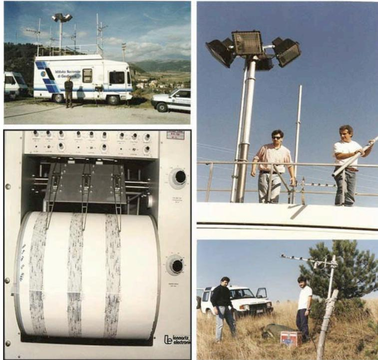
**Figura 4.** Alcuni momenti durante l'emergenza sismica seguita al terremoto Umbria Marche del 26 settembre 1997. In basso a sinistra uno dei registratori su carta funzionanti all'interno del laboratorio mobile con il quale veniva analizzata la sequenza sismica in area epicentrale.
