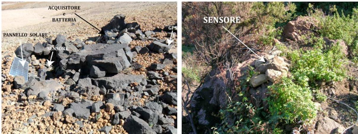
**Figura 16.** Esempio di siti temporanei con strumentazione mimetizzata con l'ambiente.
