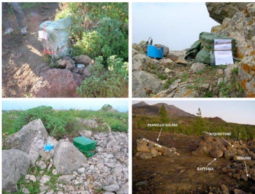
**Figura 2.** Alcuni esempi di stazioni temporanee installate in alcuni esperimenti sismici: a Stromboli nel 2006 [Marsella E. et al., 2007], in Sicilia nel 2007-2010 [Moretti et al., sottomesso a Quaderni di Geofisica] e a Tenerife, Canarie nel 2009 [Moretti e Govoni, 2010].
