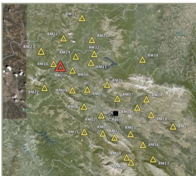
RM20 è stata installata inizialmente fornita solo del velocimetro. L'accelerometro è stato aggiunto al primo controllo il 15 Aprile.
