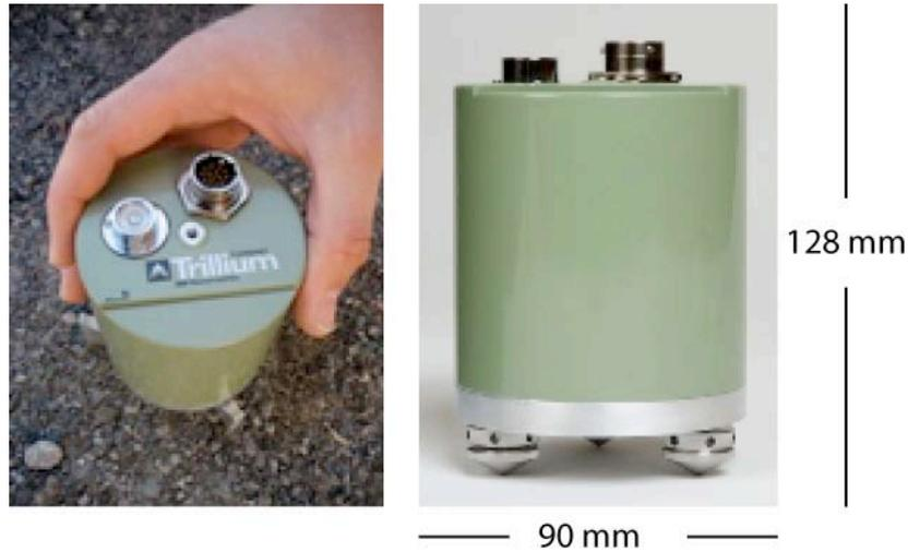
**Figura 3.** Sensore *Trillium Compact 120 s* della *Nanometrics* a corredo della stazione RM29 dal 16 Ottobre 2009 (vedi Allegato B, scheda stazione RM29).
