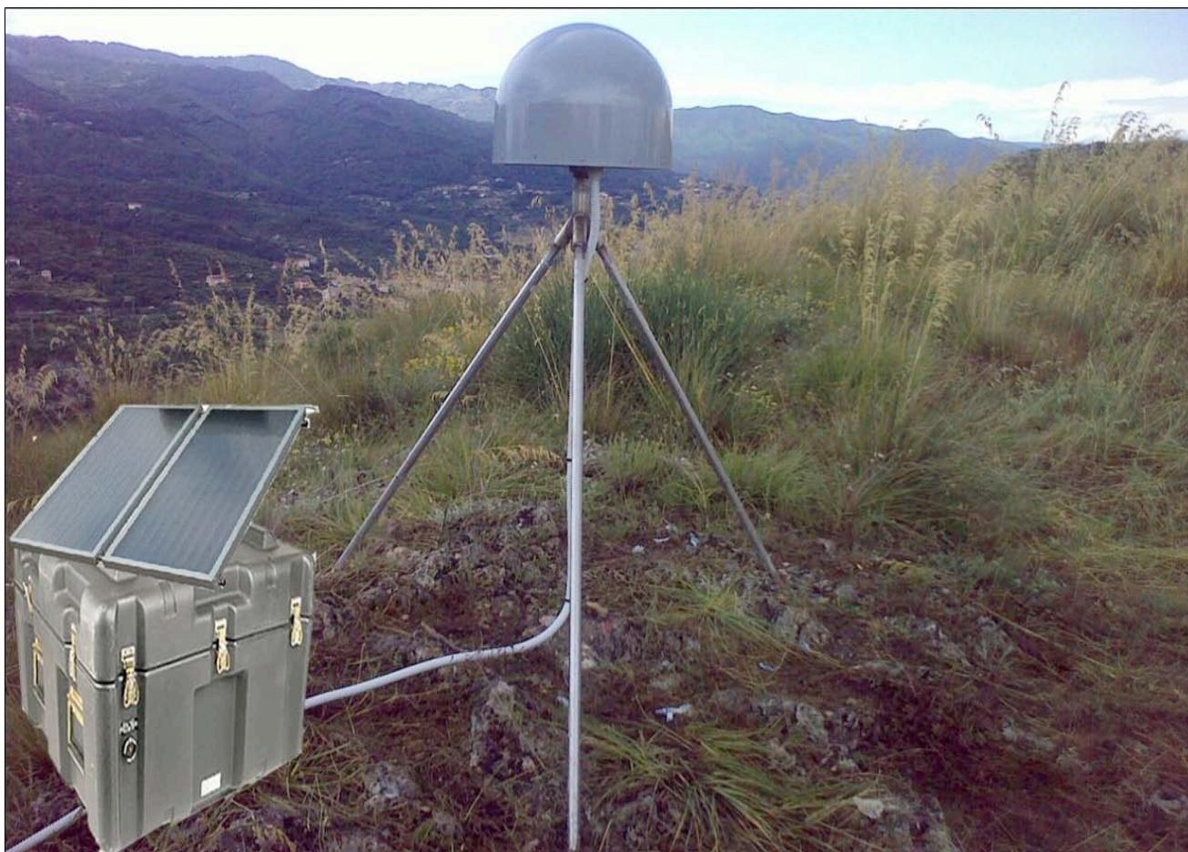
**Figura 11.** Simulazione di installazione di una futura stazione GPS permanente di pronto intervento.
