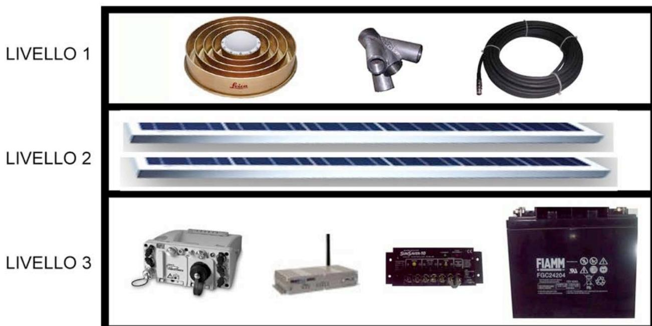
**Figura 10.** Prototipo GPS permanente di pronto intervento (sopra e pagina precedente).
