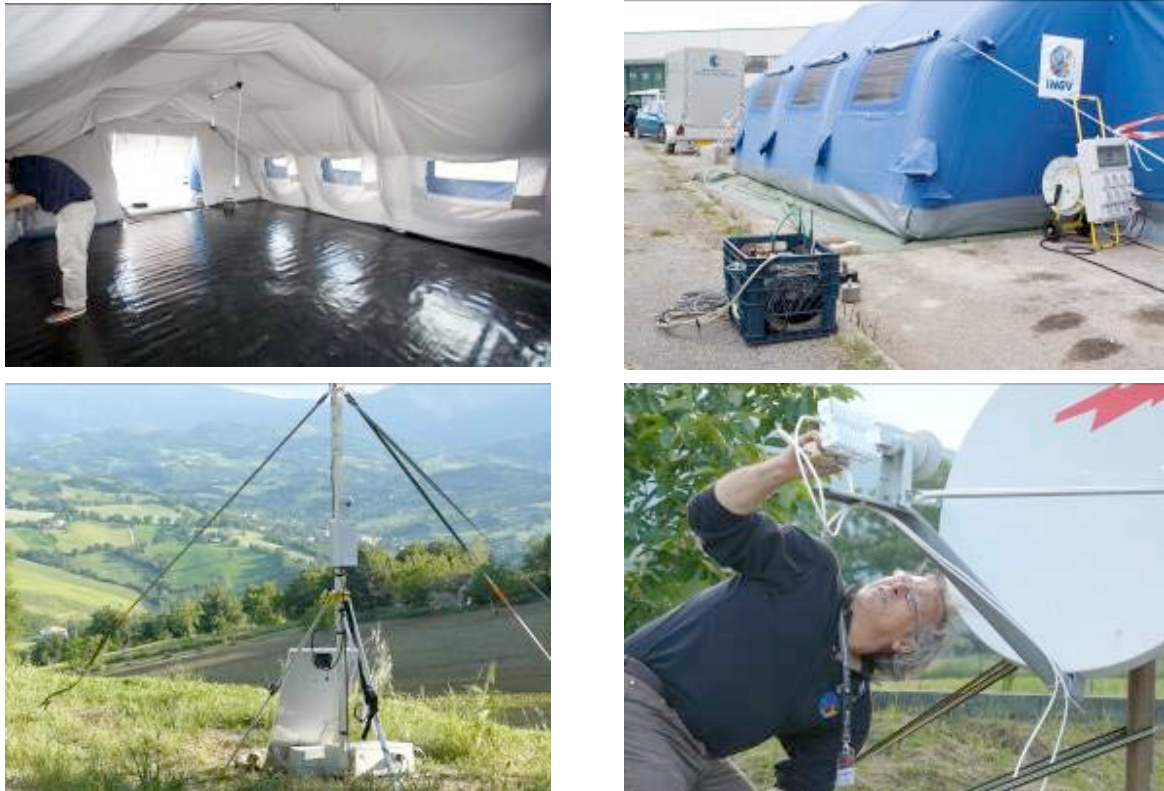
Figura 9. Alcuni momenti dell'esercitazione "Operazione Blue Mountains " in area epicentrale. In alto: interno della tenda in dotazione al COES durante la fase di montaggio e particolare dell'esterno dove era stata installata una stazione sismica stand-alone . In basso: una delle stazioni della Re.Mo.Tel. e un operatore nell'allestimento della parabola satellitare utilizzata per la trasmissione in real-time dei dati al sistema di acquisizione della Sala di Sorveglianza Sismica di Roma.
