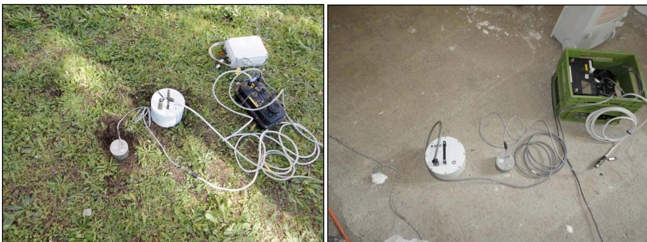
**Figura 13.** Stazione sismica in acquisizione durante le misure effettuate 8 marzo 2011 presso il Museo Archeologico di Aidone: sulla sinistra la stazione in acquisizione al punto 5, esterno al museo; sulla destra la stazione in acquisizione al punto 1, interno al museo e sito d'installazione dell'Afrodite di Morgantina.
