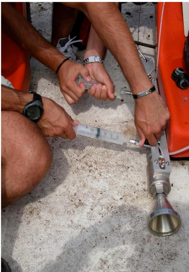
**Figura 2.** Immissione in siringa di un volume noto di acqua campionata in presenza di soluzione alcalina, con la formazione di un precipitato costituito da carbonato di Sr ed idrossidi.
