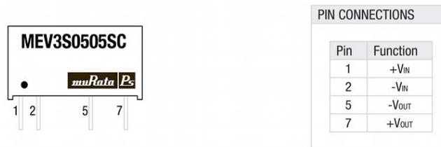
**Figura 1.1.3** MEV3S1205SC: disposizione e nomenclatura dei pin.
