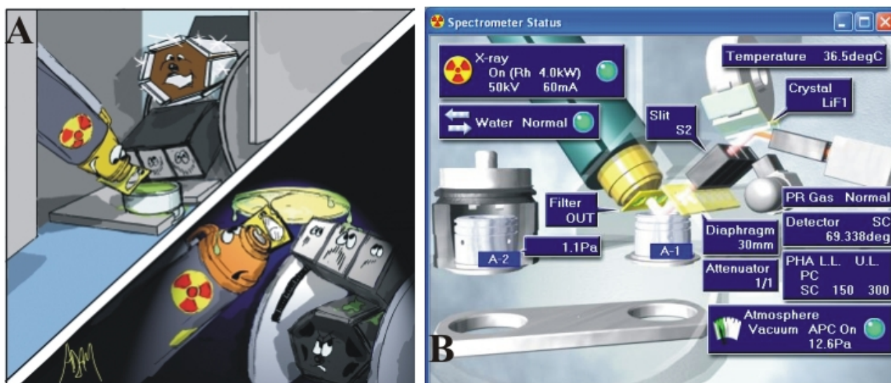
Figura 2. A) In alto è schematizzata la geometria Tube Above (il tubo è posto sopra il campione), in basso invece è schematizzata la geometria Tube below (il tubo è posto sotto il campione); B) immagine che schematizza la struttura interna dello ZSX Primus II.
