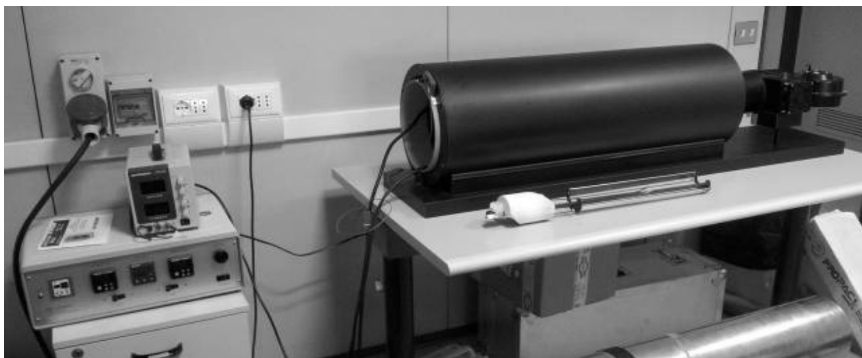
Figura 1. Il forno ASC TD-48SC per la misura delle paleointensità del Laboratorio di Paleomagnetismo dell'INGV.
