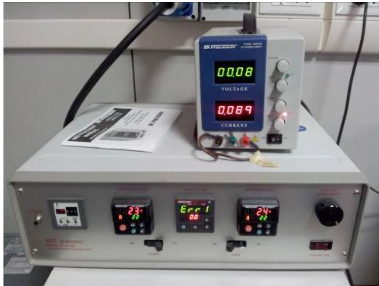
Figura 4. Vista complessiva del forno e del generatore di corrente; da sinistra, si notino il timer per la ventola, i commutatori di accensione del controller e di accensione del forno, l'interruttore della ventola e la manopola di regolazione della temperatura del forno. Sopra, si noti l'alimentatore impostato come generatore di corrente (led rosso acceso).
