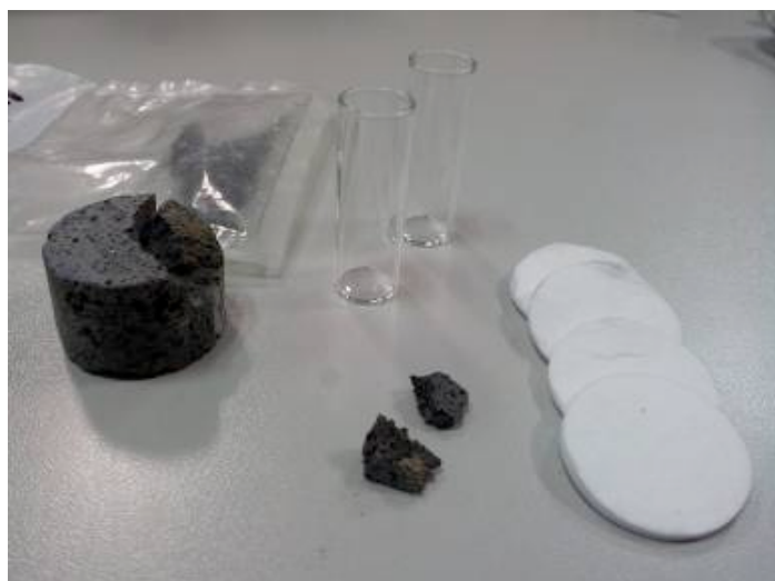
Figura 3. A destra si mostrano un campione standard paleomagnetico, alcuni frammenti ricavati dal campione, i filtri di carta di quarzo e i tubi di quarzo; a sinistra si vedono i provini contenenti i frammenti di campioni fissati con i filtri, immersi di colla e asciutti, pronti per essere analizzati.
