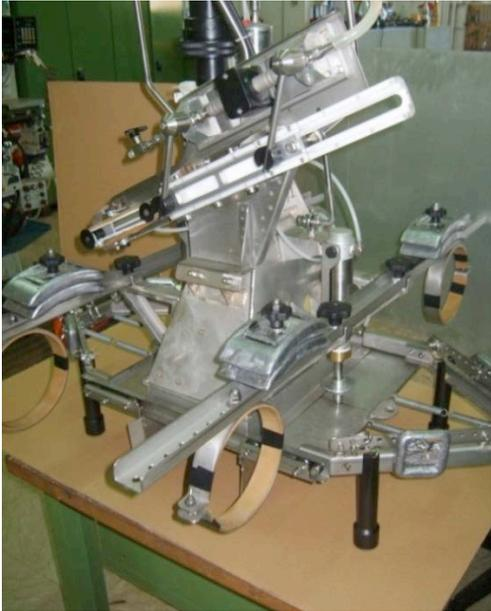
**Figura 8.** Le piastre di fondo in posizione di apertura. Visibile uno dei due attuatori pneumatici e le molle di trazione per l'apertura delle piastre.
