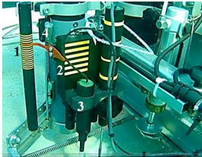
**Figura 21.** Sonde di pH e temperatura con la graduazioni di verifica dell’effettiva entità della loro penetrazione nei sedimenti.
