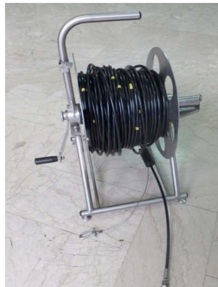
**Figura 15.** Rocchetto avvolgicavo, con terminale d'innesto per l'aria compressa.
