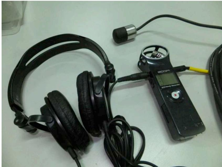
**Figura 19.** Apparato di monitoraggio idro-acustico costituito da un idrofono collegato ad un amplificatore/registratore e da cuffie di ascolto.
