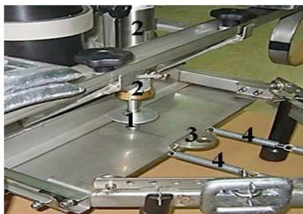
**Figura 7.** Le spine (1) di due attuatori pneumatici (2) inserite nei fori delle piastre (3), assicurano la chiusura della base dell'imbuto di captazione gas. L'azione degli attuatori libera le piastre, che vengono aperte per effetto delle molle di trazione (4).
