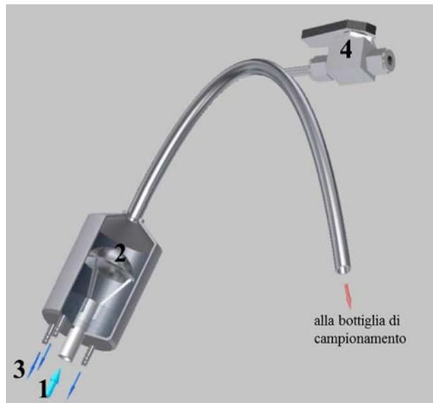
**Figura 11.** Rappresentazione 3D del decanter per la separazione dei gas dalla sospensione di acqua e sedimenti.
