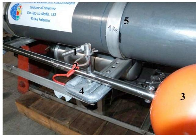
**Figura 5.** Sistema rapido dell'assetto di galleggiamento. Una levetta snodabile (1) ed una spina elastica di blocco (2) facilitano la sostituzione delle sfere di galleggiamento (3) con le zavorre (4).
