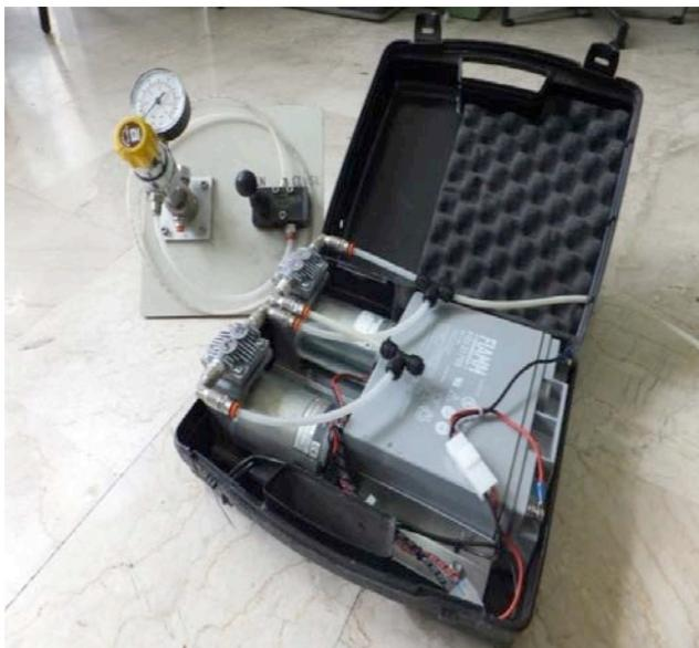
**Figura 14.** Valigetta contenente le pompe per la generazione di aria compressa e la batteria a 12 V. In alto a sinistra è visibile la leva di controllo.
