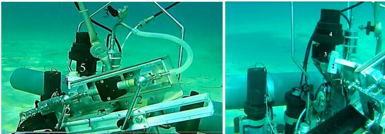
**Figura 13.** Sistema di campionamento dei gas e dispositivo per l'attivazione di una sirena.
