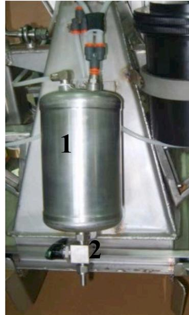
**Figura 9.** Polmone in acciaio inox (1) con valvola *swagelok* posta in basso (2).
