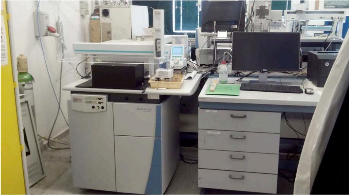
**Figura 2.** Spettrometro Delta V interfacciato al Gas Bench II.
