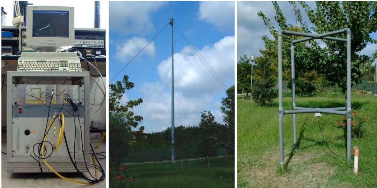
La ionosonda *Advanced ionospheric Sounder AIS-INGV* con la quale vengono effettuati i sondaggi ionosferici di routine degli osservatori di Roma, Gibilmanna, Tucuman e Bahia Blanca.
