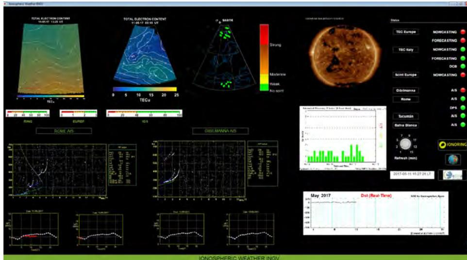
Prototipo del servizio "Ionospheric weather service" attivo nei laboratori INGV. Tutti i dati degli osservatori e stazioni ionosferiche sono integrati nel prototipo. Tra i prodotti di previsione ionosferica in tempo reale è presente IONORING basato sulla rete geodetica "RING" gestita dall'INGV.
