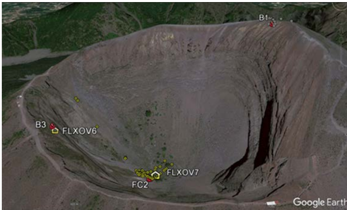
Figura 5.2.1. Ubicazione delle stazioni multiparametriche della rete di monitoraggio dell'OV in area di bordo e di fondo cratere e dei siti dove sono eseguite le attività di sorveglianza geochimica in area craterica.
