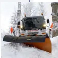
La UNI EN 15432-1 specifica i requisiti di progettazione delle piastre di montaggio fisse al veicolo porta-attrezzi, con il fine di garantire l'intercambiabilità tra uno stesso veicolo e differenti attrezzature che vengono ad esso fissate anteriormente (lama, fresa...).
