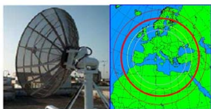
Antenna L BAND AVHRR-NOAA operata da INGV-CNT
