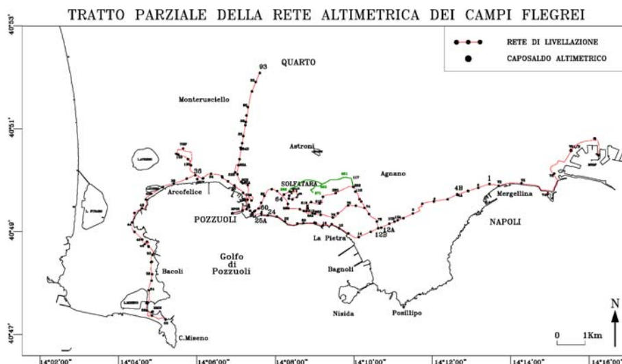
Fig. 4.1.5. 2 - Parte della Rete Altimetrica dei Campi Flegrei misurata nel Luglio 2010. E' riportato anche un nuovo tratto realizzato in località Fumarole Pisciarelli
