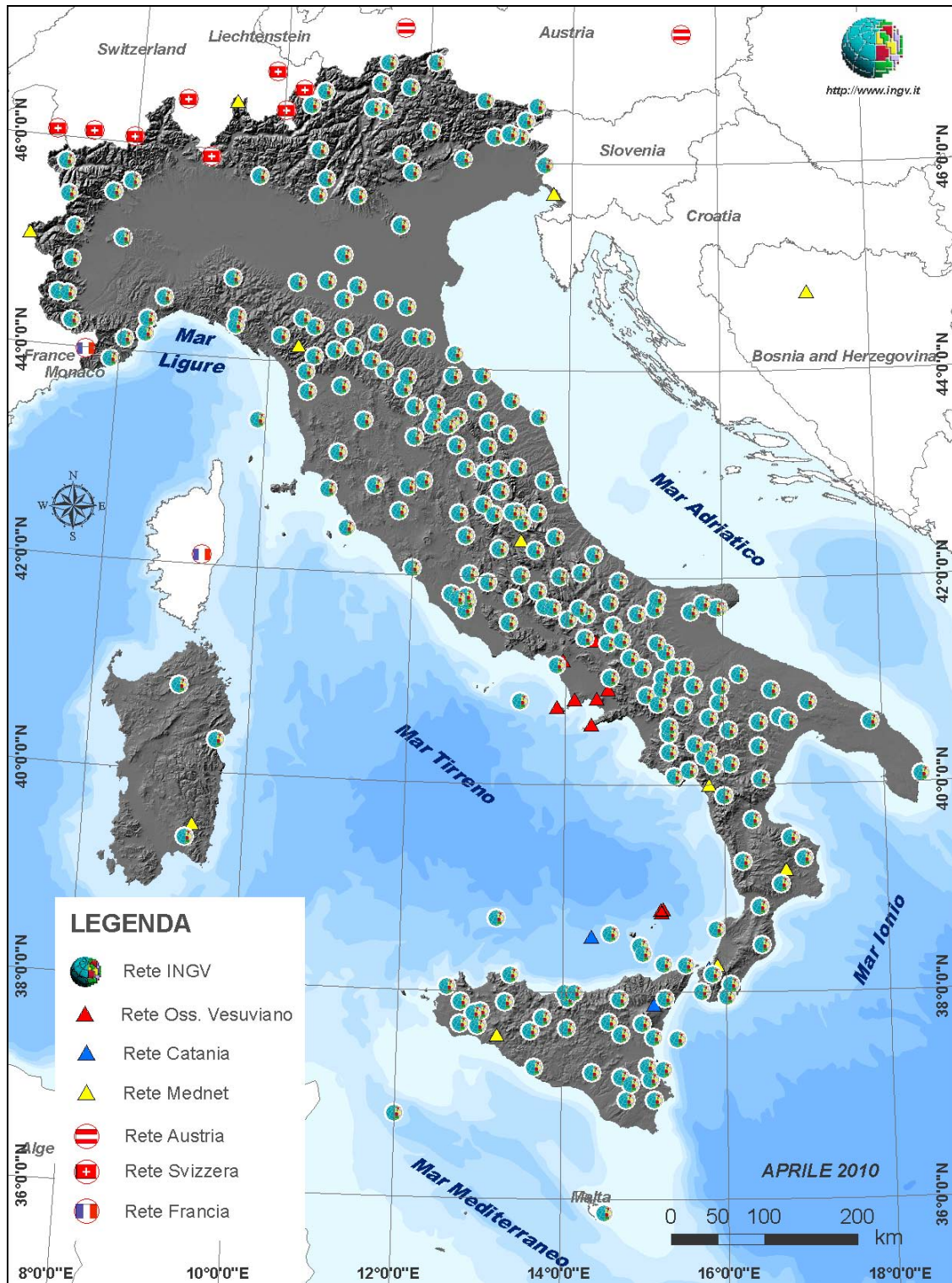
Figura 1.2.1 – Mappa della rete sismica nazionale dell'INGV.
