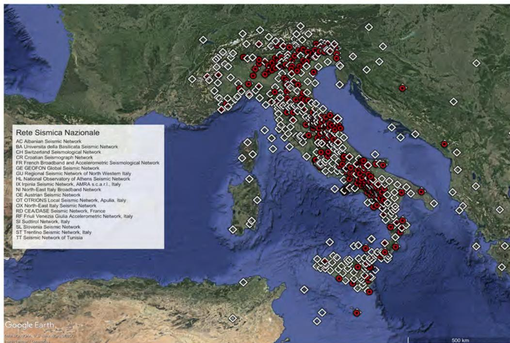
Figura 3.1.1 - Mappa della Rete Sismica Nazionale. Sono indicate con il rombo bianco le stazioni dotate di velocimetro e con il cerchio rosso quelle dotate di accelerometro. Nel riquadro sono indicate le reti che contribuiscono con stazioni non gestite da INGV.
