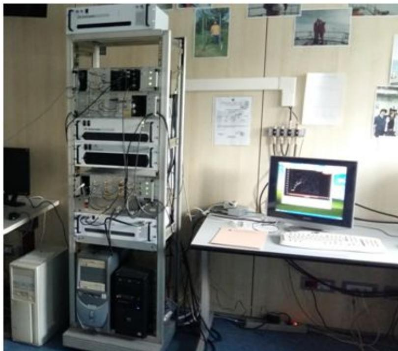
*La ionosonda AIS-INGV è un radar HF a frequenza variabile completo di software per l'interpretazione automatica degli ionogrammi (Autoscala), sviluppati all'INGV. Con essa vengono effettuati i sondaggi ionosferici di routine degli osservatori di Roma e Gibilmanna. La ionosonda AIS-INGV è inoltre utilizzata negli osservatori di Tucumán e Bahía Blanca, in Argentina.*
