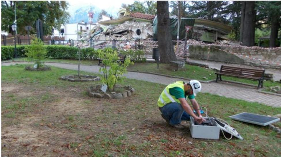
*Installazione di una stazione sismica durante una emergenza sismica, finalizzata a studi di microzonazione sismica.*
