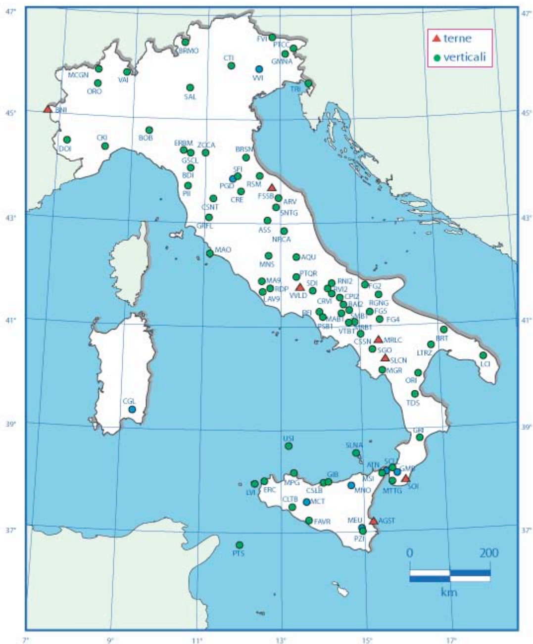
Fig. 3. La Rete Sismica Nazionale Centralizzata.
