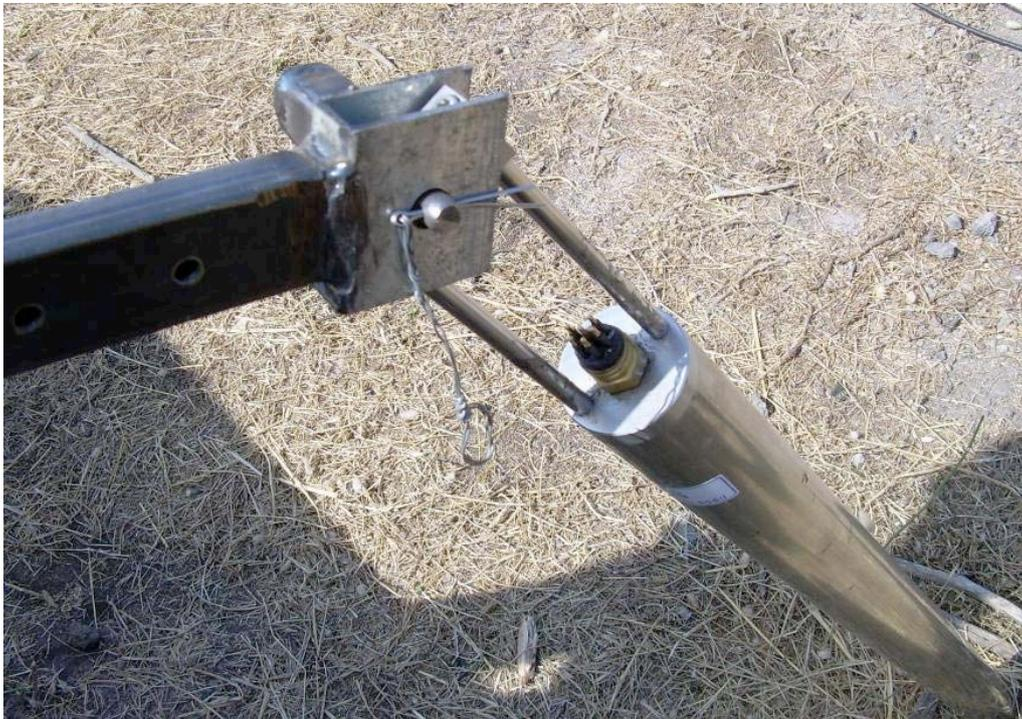
Fig. 6. Particolare dell'innesco del clinometro Lily con il sistema delle aste.
