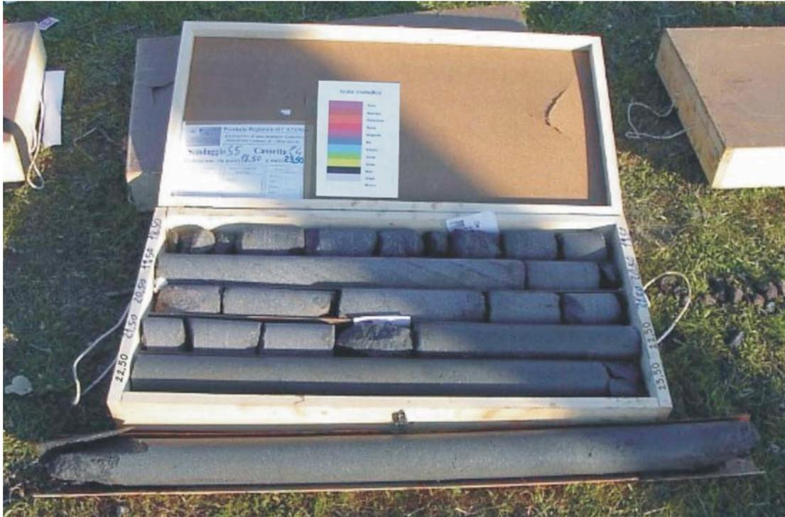
Fig. 5. Bancone lavico massivo e poco fratturato da m 18,50 a m 25,00.
