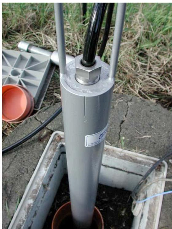
Fig. 1. Fase d'installazione di un clinometro *bore-hole*.
