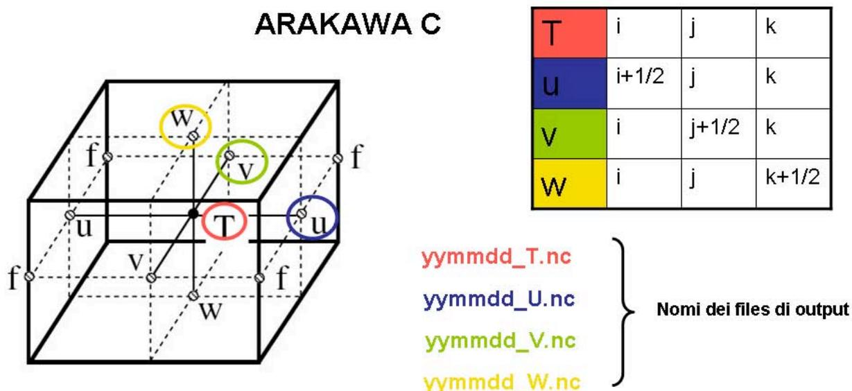
**Figura 12** Descrizione della griglia staggerata utilizzata dal modello numerico utilizzato da MFS e dei rispettivi files di output.
