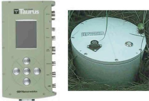
**Figura 4.** Coordinate delle stazioni e strumentazione utilizzata (stazione digitale Nanometrics Taurus e sensore broadband a tre componenti Lennartz LE-3D 20 sec).
