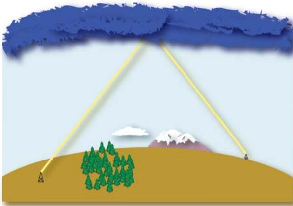
Infatti le onde radio emesse da una stazione trasmittente collocata sulla superficie terrestre vengono assorbite e/o riflesse dalla ionosfera, a seconda della frequenza del segnale.
