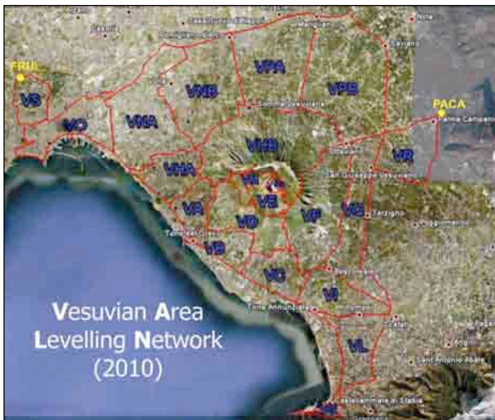
Fig. 4.1.6. - Rete di livellazione nell'area vesuviana (VALN). In giallo sono riportate le stazioni CGPS (PACA e FRUL) unite alla rete di livellazione con appositi circuiti.
